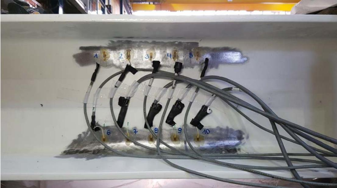
Abbildung 5-1: Dehnmessstreifen (DMS) mit Nummerierung an HEA300
