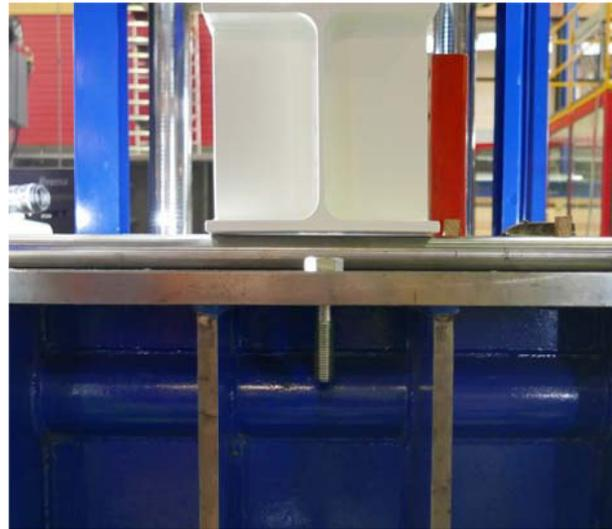
Abbildung 5-24: HEA 300 schräge Flansche am Auflager
