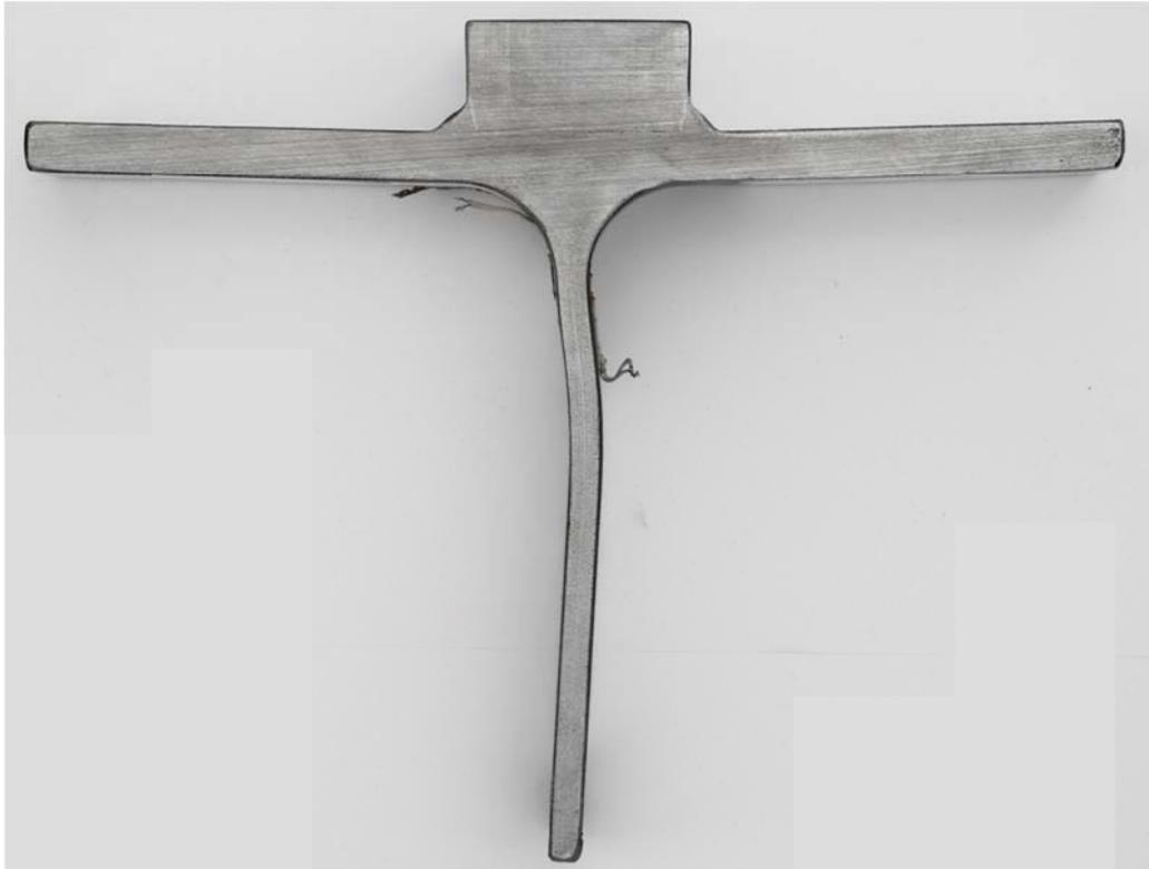
Abbildung 5-16: HEA 300 nach Traglastversuch
