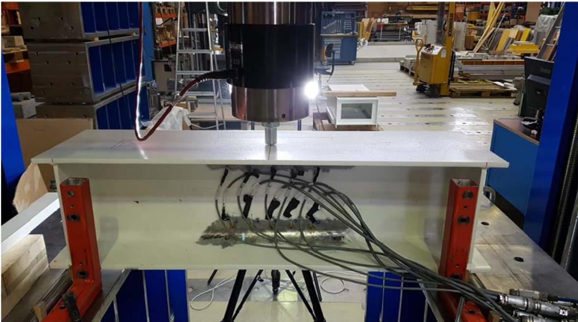
Abbildung 5-3: Versuchsaufbau HEA300 ohne Schiene
