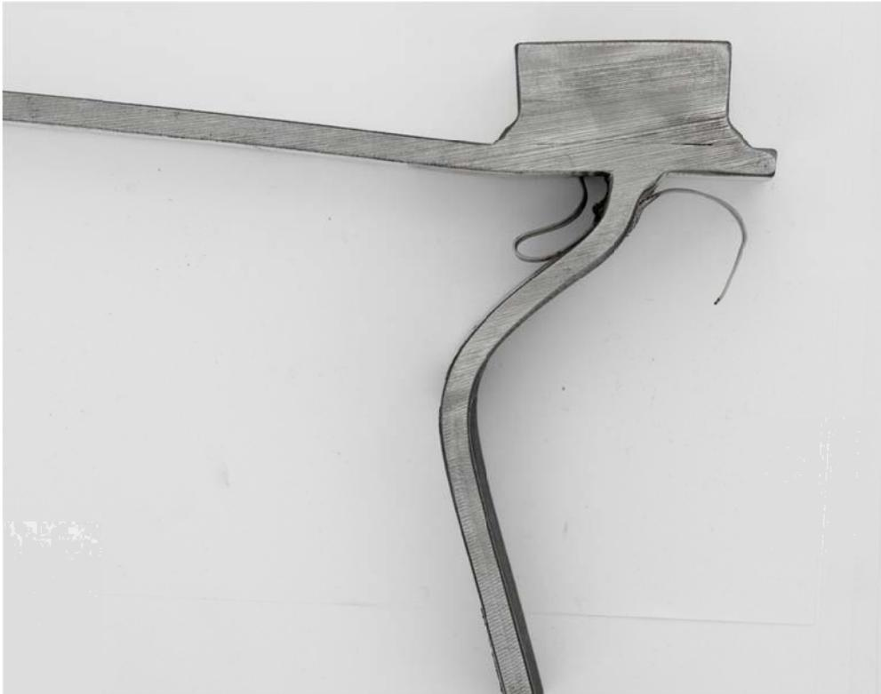
Abbildung 5-18: Kastenquerschnitt 1 nach Traglastversuch
