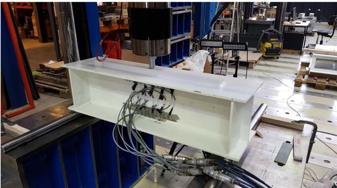
Abbildung 5-6: Versuchsaufbau HEA300 mit aufgeschweißter Schiene
