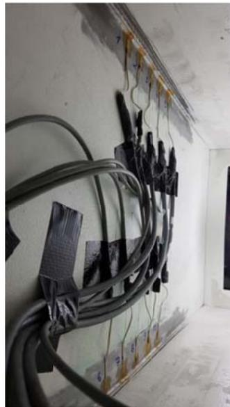
Abbildung 5-8: Dehnmessstreifen (DMS) im inneren des Hohlkastens
