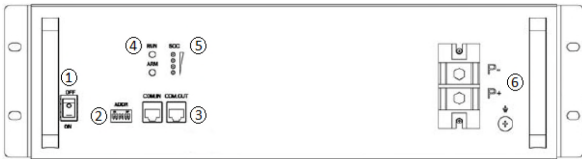
Abbildung 3.14: BYD U3A1-50P-A Batteriespeicher
