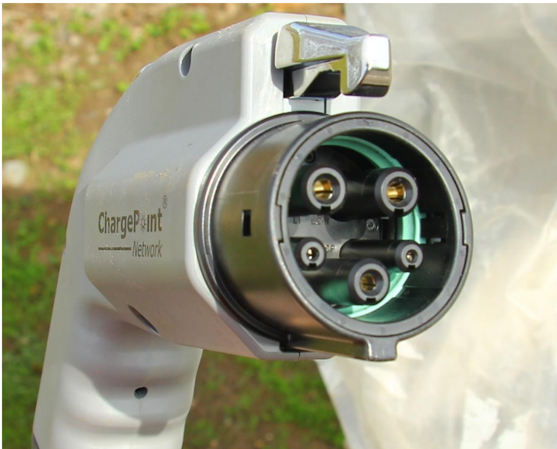
Abbildung 5: Typ1-Stecker (Wikimedia Commons)
