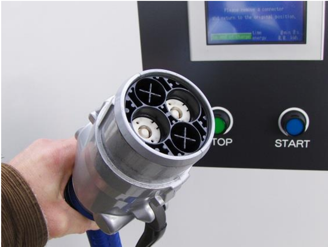
Abbildung 7: CHAdeMO-Stecker (Wikimedia Commons)
