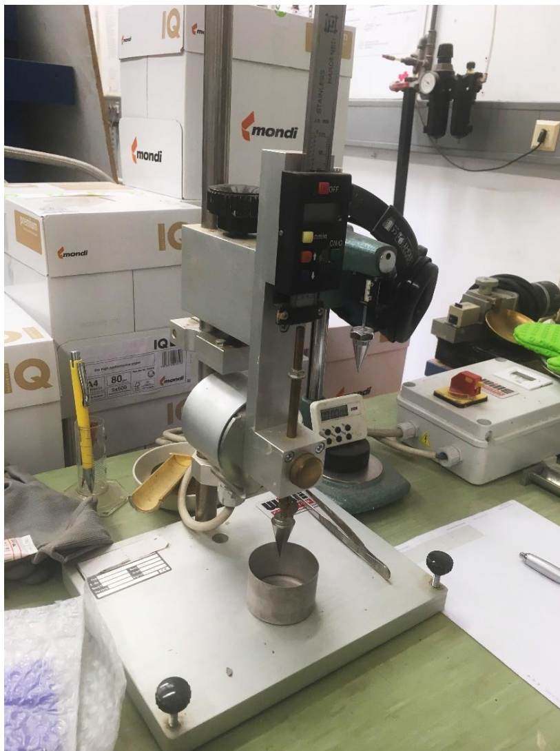
Abb. 23: Fallkegelgerät gemäß ÖNORM B 4411:2009
