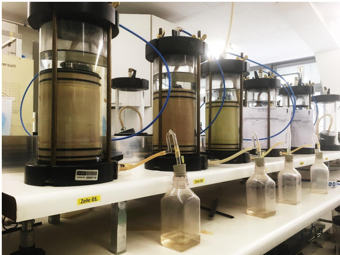
Abb. 29: Triaxiale Durchlässigkeitszellen im Labor des Instituts für Bodenmechanik und Grundbau der TU Graz
