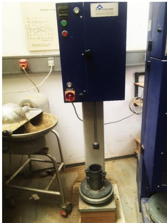
Abb. 27: Proctorgerät gemäß ÖNORM B 4418:2012
