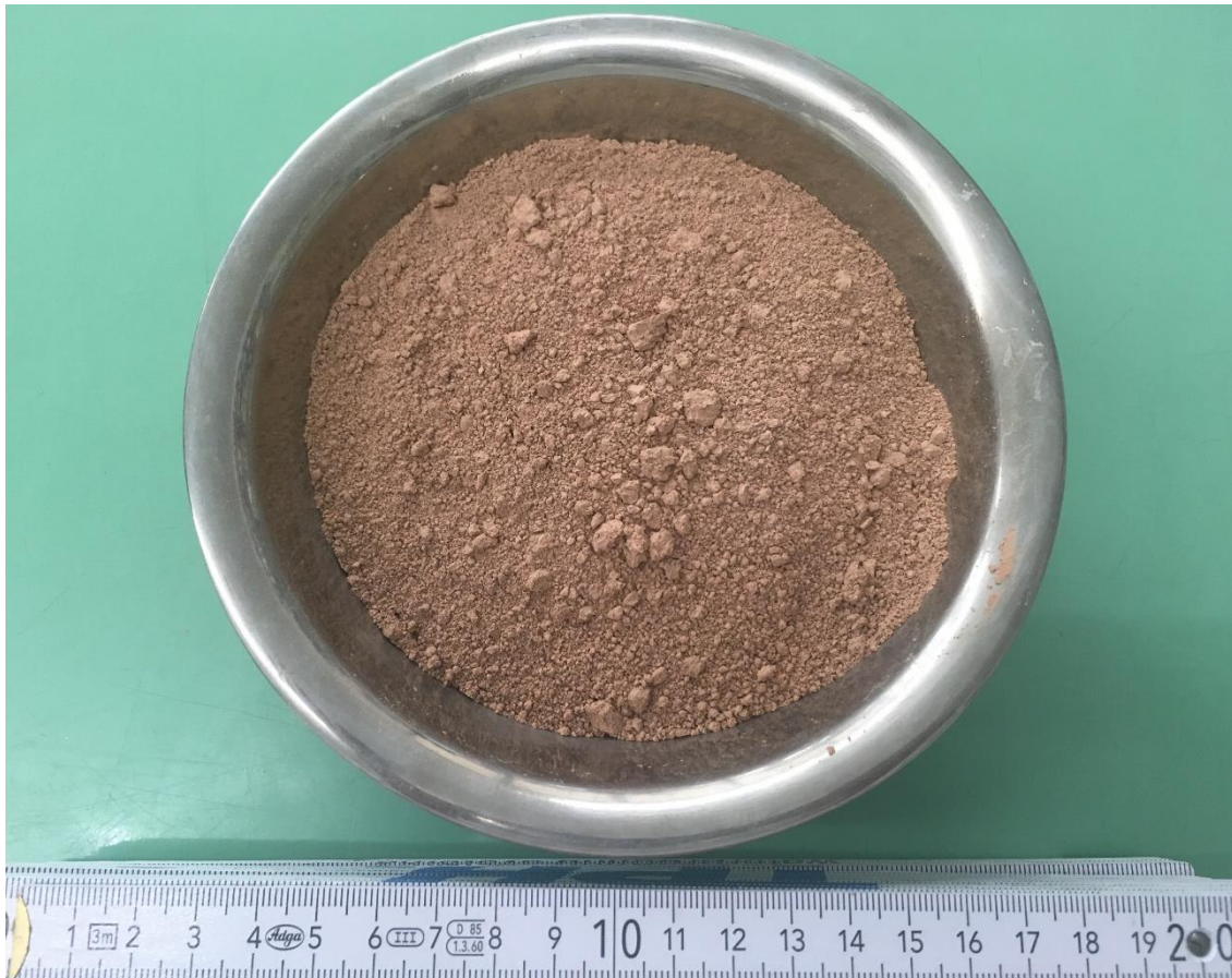
Abb. 20: Zu Ziegelpulver gemahlenes Ziegelrecyclingmaterial
