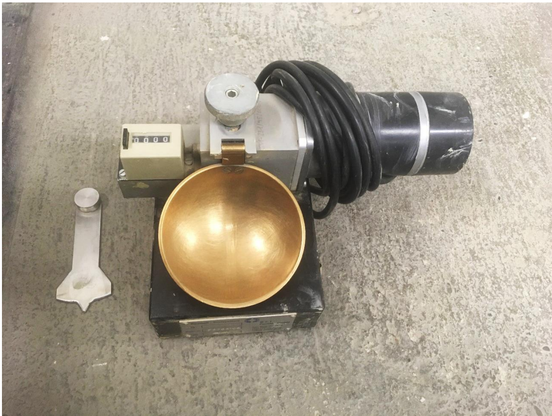
Abb. 24: Fließgrenzengerät nach Casagrande gemäß ÖNORM B 4411:2009
