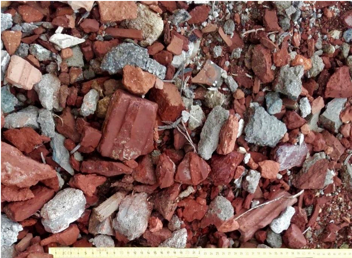
Abb. 19: Unaufbereitetes Ziegelrecyclingmaterial vor der Zerkleinerung
