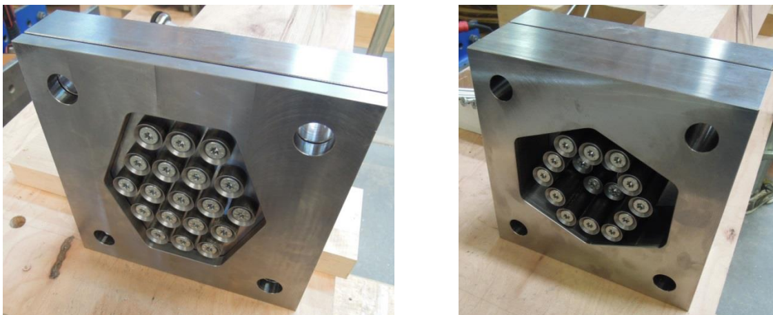
Abbildung 6-6 Stahlkranz und Distanzhülsen: links: Serie BU_01_01 (konstante Einbindetiefe); rechts: Serie BU_01_02 (parabelförmige Abstufung der Einbindetiefe)
