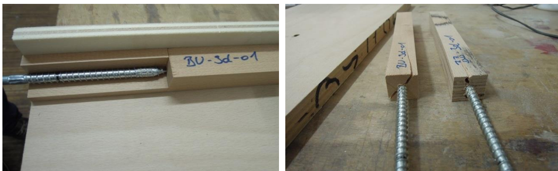
Abbildung 4-1 links: Versuchsaufbau zum Einschrauben inkl. Winkel als Einschraublehre; rechts: aufgespaltene Körper aus Buche und BauBuche
