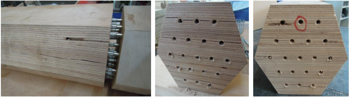
Abbildung 6-10 Versagensbilder: links: Prüfkörper nach Versagen (BB_02_01_05); Mitte: Versagen bei konstanter Einbindetiefe (BB_02_01_05); rechts: Versagen bei parabelförmige Abstufung der Einbindetiefe (BB_02_02_05) (roter Kreis signalisiert Schraubenbruch)
