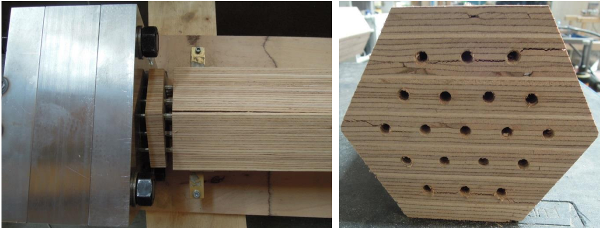
Abbildung 6-12 Versagensbilder: links: Prüfkörper nach Versagen (BBq_03_01_01); rechts: Versagen bei parabelförmiger Abstufung der Einbindetiefe (BBq_03_01_05) – Risse zwischen den eingeklebten Querlagen
