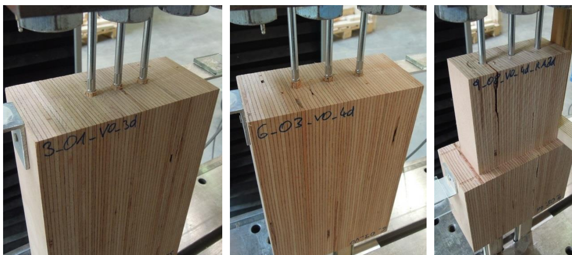
Abbildung 5-9 Versagensbilder: links: Serie 3_01 mit augenscheinlich kaum sichtbaren Rissen zwischen den Schrauben; Mitte: Serie 3_03 Ausziehen ohne augenscheinlich sichtbare Risse; rechts: Serie 3_08 Aufspalten des Probekörpers
