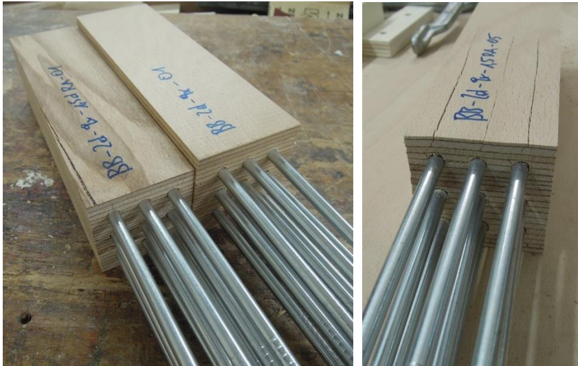
Abbildung 4-3 links: eingeschraubte Schraubengruppen; rechts: aufgespaltener Probekörper
