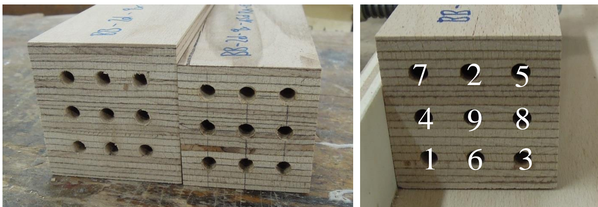
Abbildung 4-2 links: Probekörper mit Randabstand 2 d und Probekörper mit Randabstand 1,5 d ; rechts: Einschraubreihenfolge
