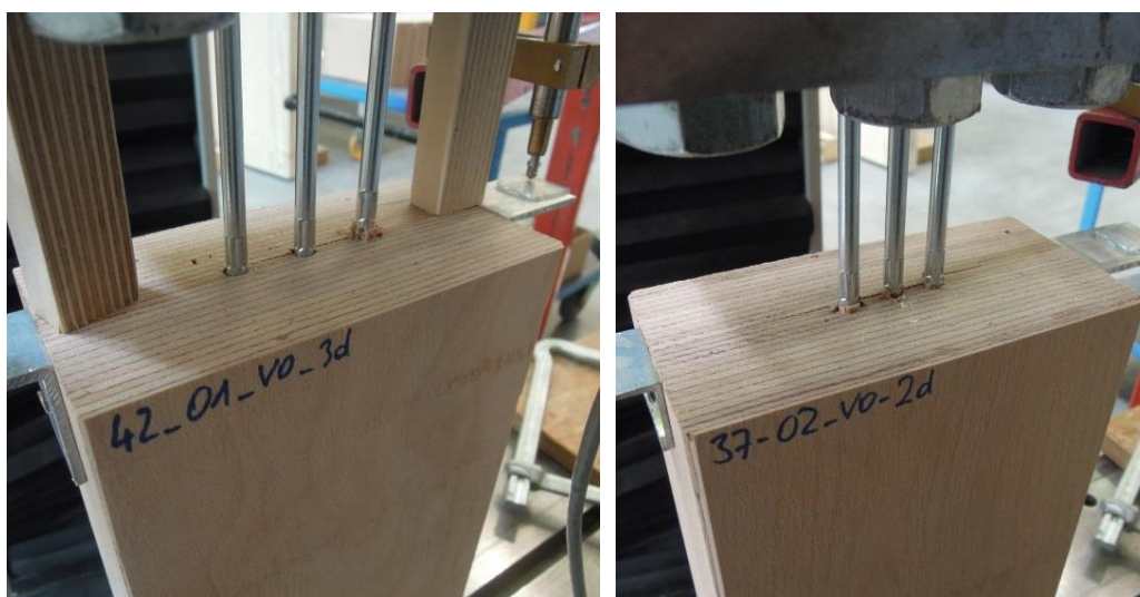
Abbildung 5-7 Versagensbild: links bei Serie 2_01; rechts bei Serie 2_02
