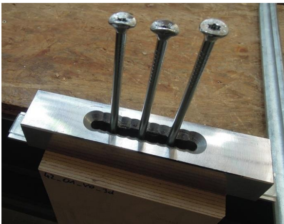
Abbildung 5-8 Serie 2_01: Schrauben in Stahlschiene gezogen
