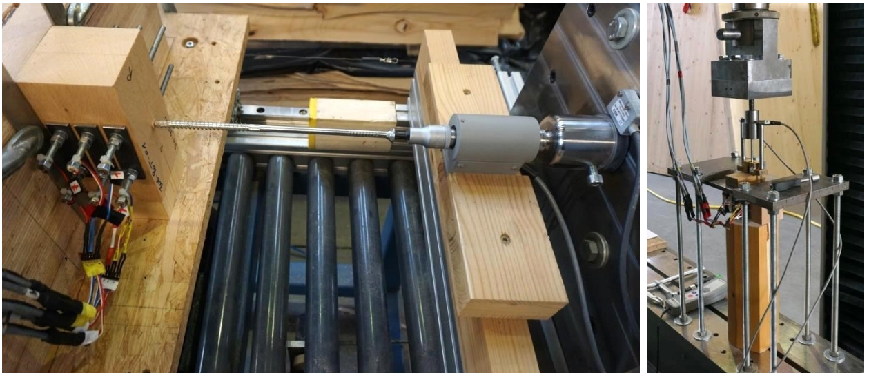
Abbildung 31: Prüfaufbau zur Bestimmung der Spaltkräfte mit den Messschrauben
