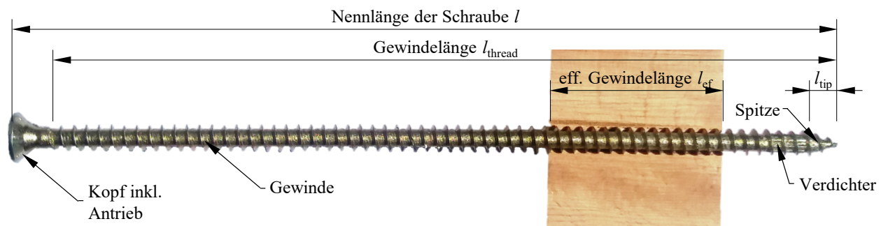
Abbildung 11: Bausteine mit dazugehörigen Abmessungen für das "System Schraube"
