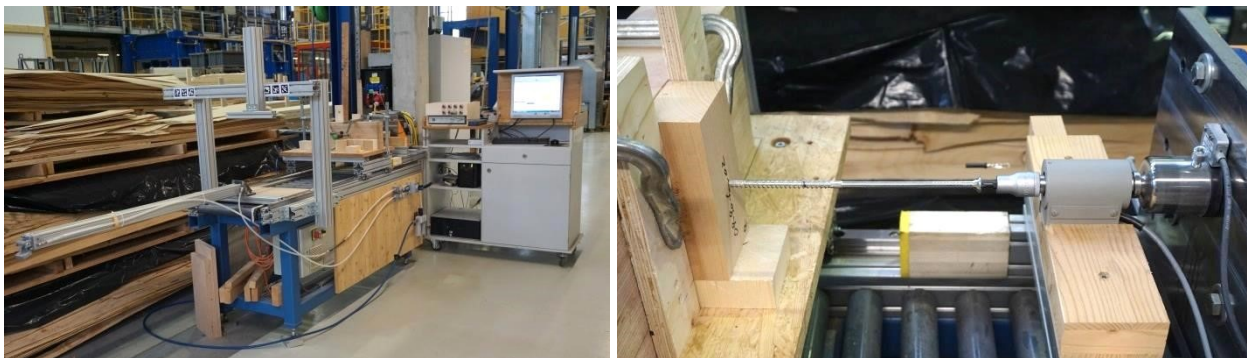
Abbildung 28: Prüfaufbau für die Eindrehprüfungen
