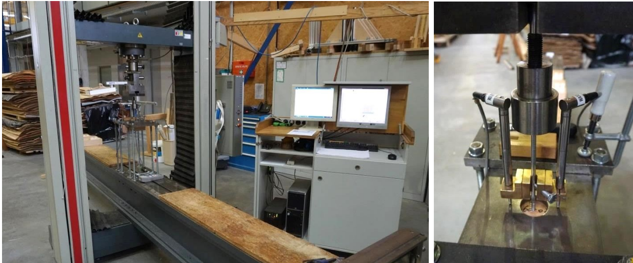
Abbildung 29: Prüfaufbau für die Ausziehprüfungen
