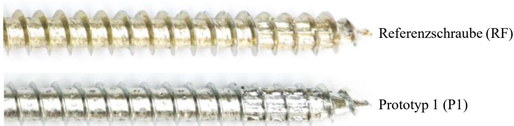
Abbildung 26: Gewinde und Spitze von Referenzschraube und Prototyp 1
