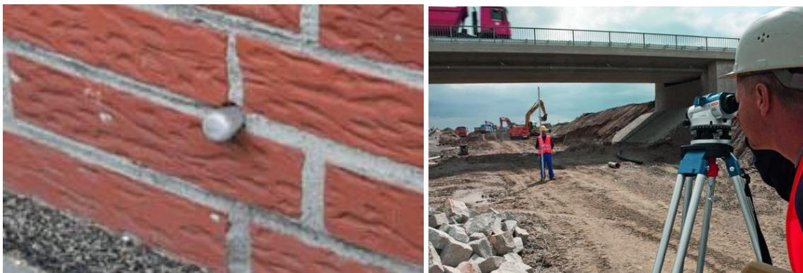
Abb. 134 Linkes Bild: Höhenbolzen zur Bestimmung von Niveauänderungen (Mollinga,2012); Rechtes Bild: Höhenbestimmung mittels Nivelliergerät und Messlatte<sup>83</sup>
