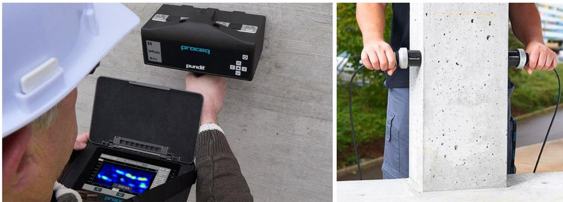
Abb. 141 Linkes Bild: Betondeckungsmessung an einer Wand mittels Ultraschall; Rechtes Bild: Untersuchung einer Betonstütze<sup>94</sup>
