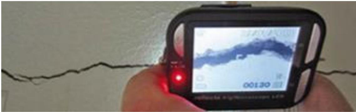
Abb. 121 Rissaufnahme mittels digitaler Risslupe (Dialer, 2016)
