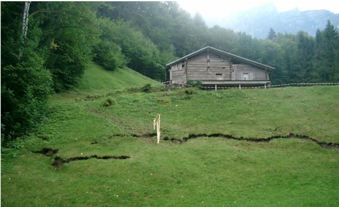
Abb. 205 Anrisskante als Hinweis möglicher Hangbewegungen<sup>125</sup>
