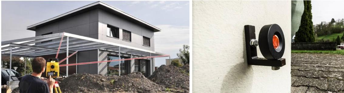
Abb. 133 Linkes Bild: Messung mittels Totalstation<sup>82</sup>; Rechtes Bild: Dauerhaft angebrachte Prisma zur periodischen Überwachung von Setzungen am Messobjekt (Aargauer Zeitung, 2015)
