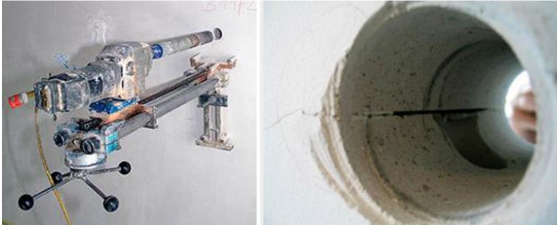
Abb. 129 Linkes Bild: Bohrkernentnahme; Rechtes Bild: Einblick in das Bohrloch mit Risschaden im Inneren einer Wand (Dialer, 2016)
