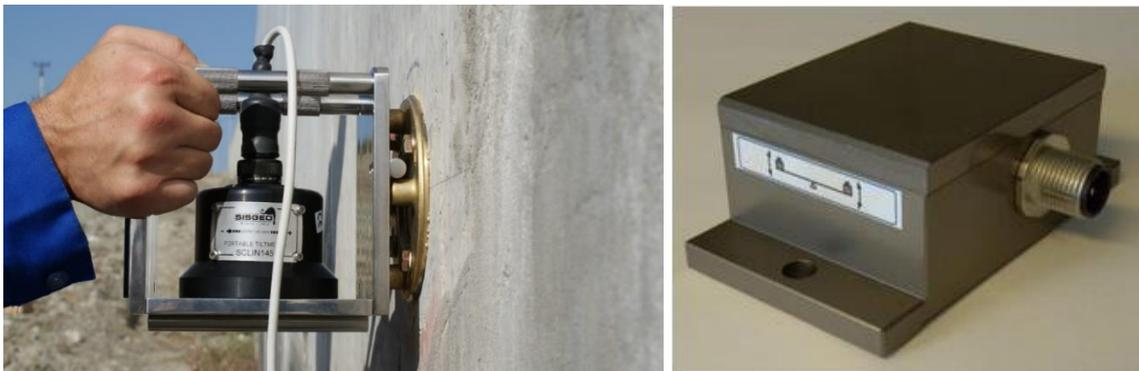
Abb. 132 Linkes Bild: Anlegen eines Neigungssensors an ein Bauwerk<sup>80</sup>; Rechtes Bild: Digitaler Neigungssensor<sup>81</sup>
