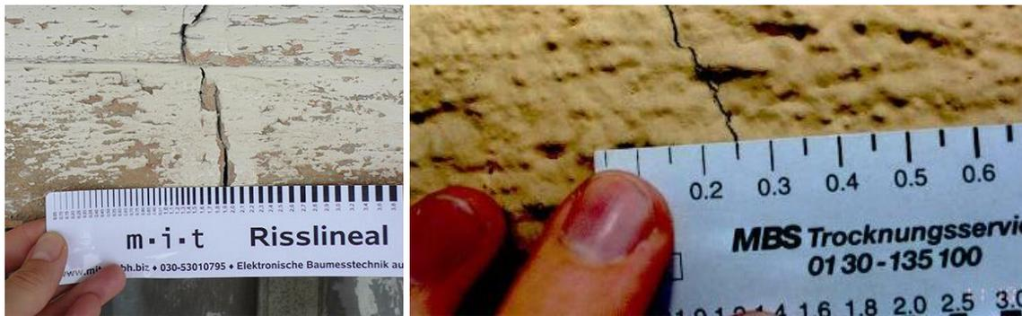
Abb. 119 Linkes Bild: Aufnahme der Rissbreite mittels Risslineal<sup>70</sup>; Rechtes Bild: Geringe Rissbreite<sup>71</sup>
