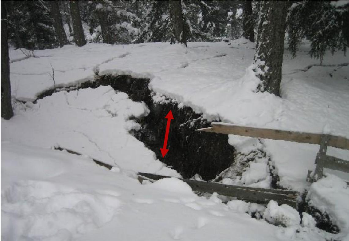
Abb. 204 Anrisskante mit erkennbarem Geländeversatz<sup>124</sup>
