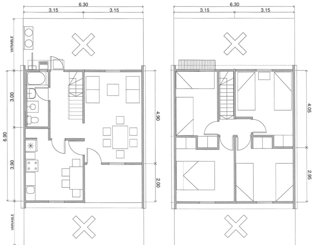
Abbildung 4.3: Grundrisse des Villa Verde Projektes von ELEMENTAL: (links: Erdgeschoss im erweiterten Zustand, rechts: Obergeschoss im erweiterten Zustand) [64]
