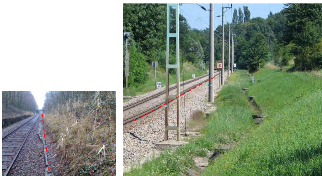
Abb. 64: Kriechhang im Bereich einer Zugtrasse (rechts: 27 ; links: Leopold, 2012)
