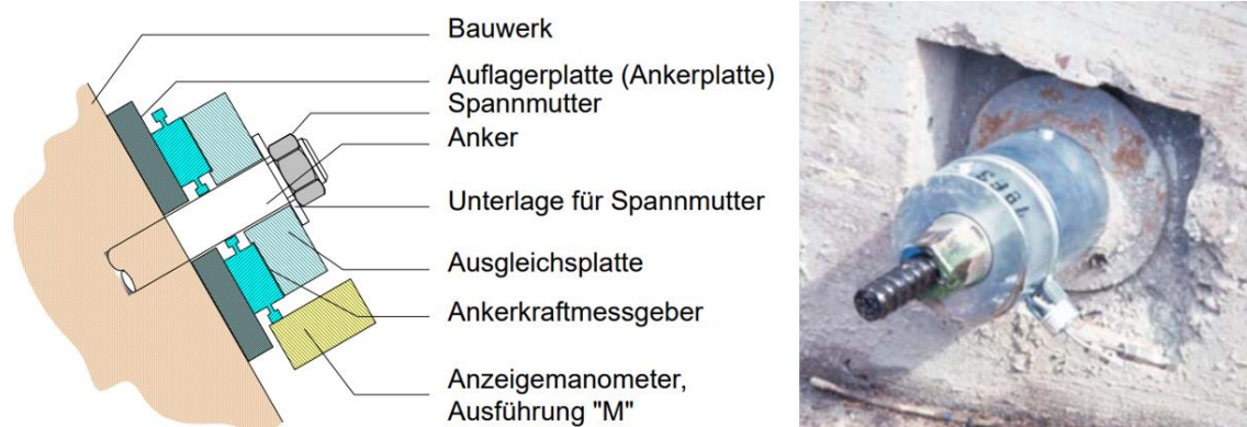
Abb. 74: Hydraulische Kraftmessdose mit Manometer direkt an der Messdose 36
