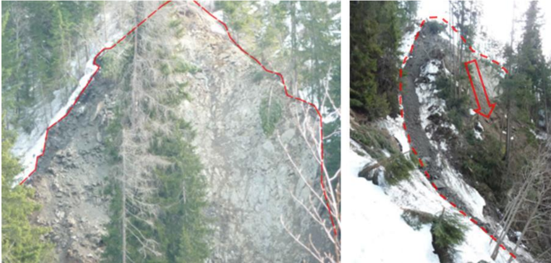
Abb. 25: Rutschung Fischergraben mit Blick auf den oberen Bereich der Rutschung und rot markierter Anrisskante; feines lehmiges Material vermischt mit groben stark zerklüfteten Blöcken liefert ungünstige Bedingungen für die Hangstabilität (adaptierte Quelle: WLV Kärnten)
