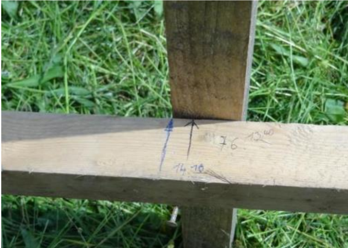
Abb. 86: Anwendung einfacher Messinstrumente zur sofortigen Überwachung der Bewegungen. (Gasperl, Tartarotti, 2014)
