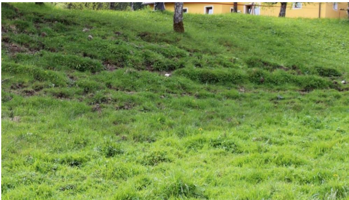
Abb. 60: Buckelbildung und kleine Anrisskanten können fälschlicherweise als Kriechang interpretiert werden, sind aber in diesem Fall durch Weidevieh entstanden.
