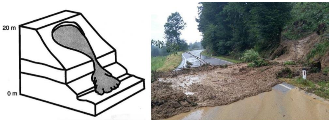
Abb. 11: links: schematische Darstellung einer Fließbewegung mit anfänglicher Gleitung (Multilingual Landslide Glossary, 1993); rechts: Hangmure 13
