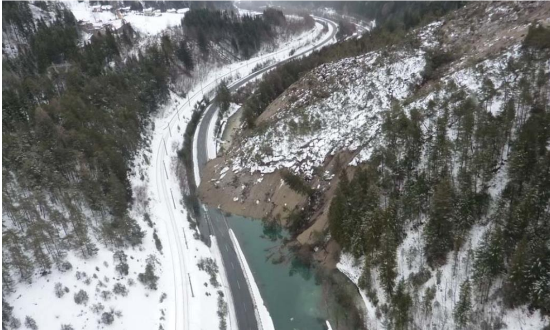
Abb. 50: Rutschung Leisach: Die Rutschmassen zerstörten die Landesstraße und verschütteten die Drau. 20
