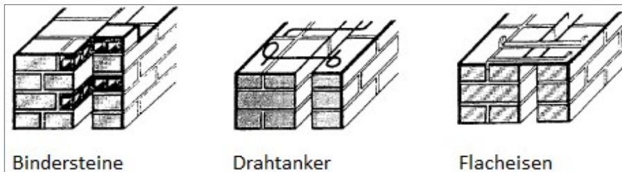
Bild 2.14 Verbindungsmöglichkeiten der Wandschalen 36
