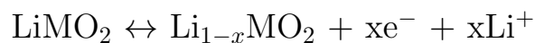
Abbildung 2.1: Zellenreaktion mit einer Anode aus metallischem Lithium und einer schichtartigen Oxid-Kathode \text{LiMO}_2 , \text{M} = \text{Co} bzw. \text{Ni}_{0,6}\text{Mn}_{0,2}\text{Co}_{0,2} ( \rightarrow Beladung, \leftarrow Entladung)
