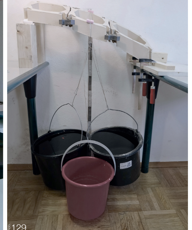
Abb. 129 Einfacher Belastungstest an Brückenkonstruktion (Wassergewichte)
