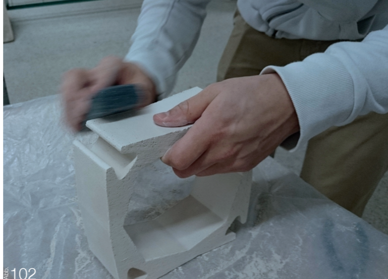
102 Nachbearbeiten/entgraten der gebrannten Module
