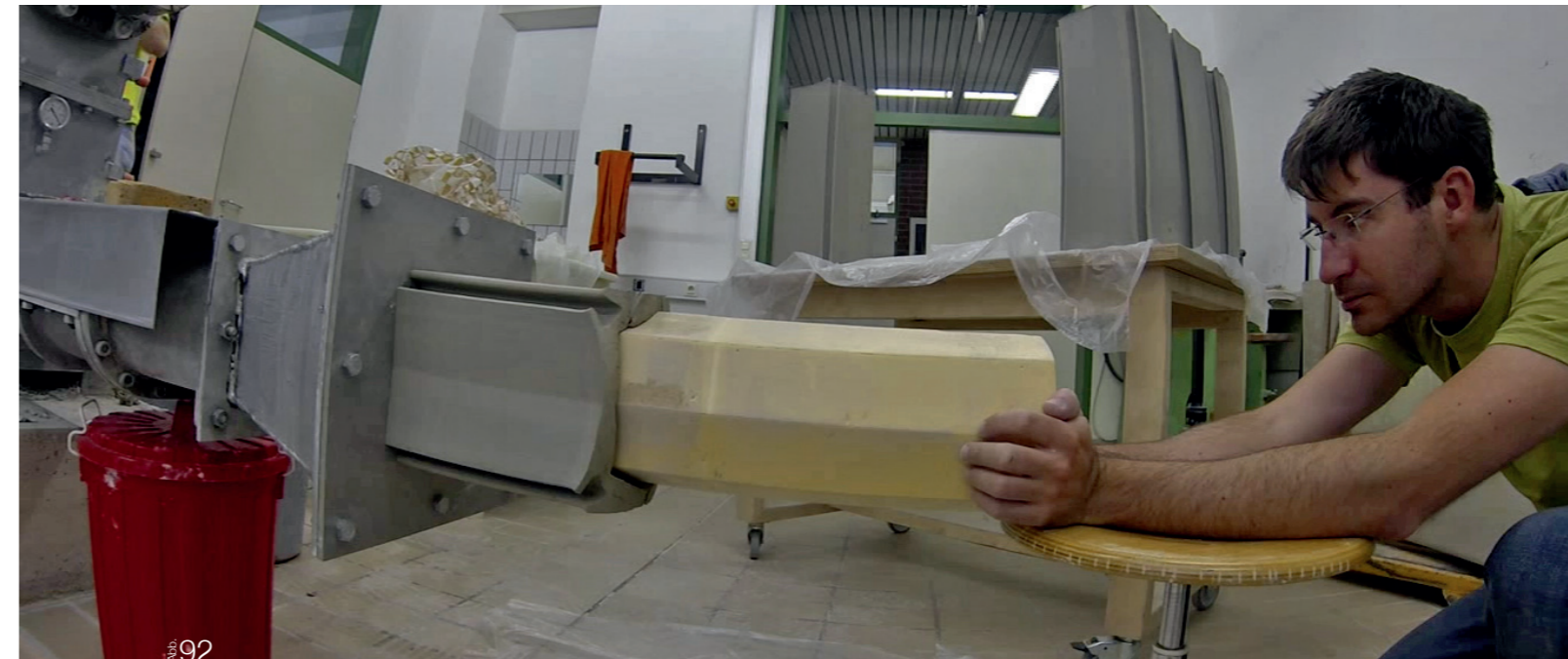
Abb. 92 Extrusion des Profils an der Strangpresse auf einen XPS-Stützkern
