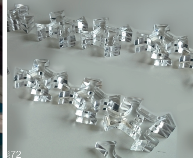
Abb. 72 Verschiedene lasergeschnittene Acryl-Verbindern
