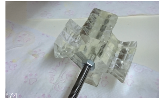
Abb. 73 Verkleben der geschnittene Acryl-Teile zu einem stabilen, strangähnlichen Profil durch Anlösen mit Dichlor-Methan.
