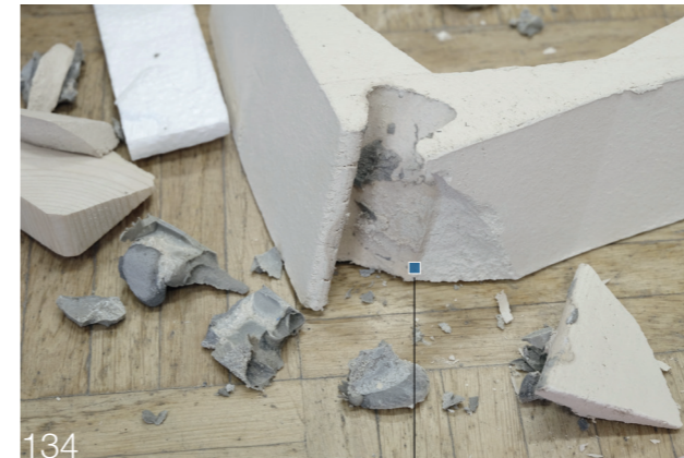
134 Bruchstelle am Verbinder, ausgehend von der inneren Kerbstelle
