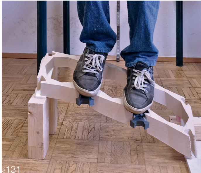
131 Zerstörende Belastung an Brückenkonstruktion
