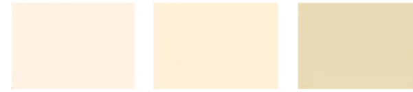
Abb. 90 Farbe des Scherbens bei verschiedenen Brenntemperaturen (1000°C | 1100°C | 1200°C)
