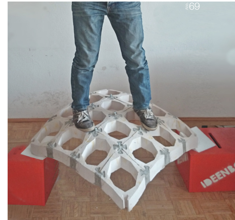
Belastung bei einer Spannweite von 1 m
