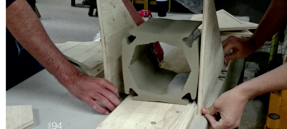
Abb. 94 Winkellehren für händisches Schneiden
