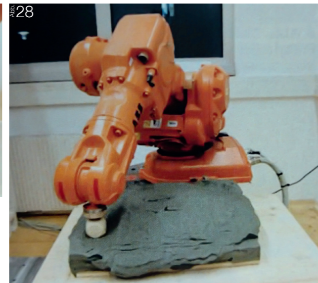
Roboter-Arm beim Formen einer Plastilin-Modelliermasse
