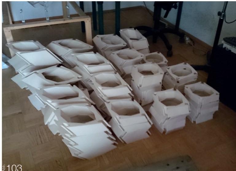
103 Montagefertige, gebrannte, nachbearbeitete und sortierte Module
