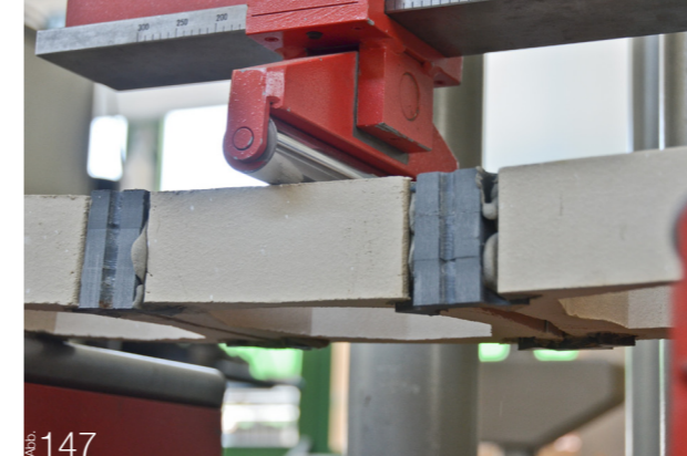
Abb. 147 Bruchbelasteter Einfeldträger im 3-Punkt-Biegezugversuch
