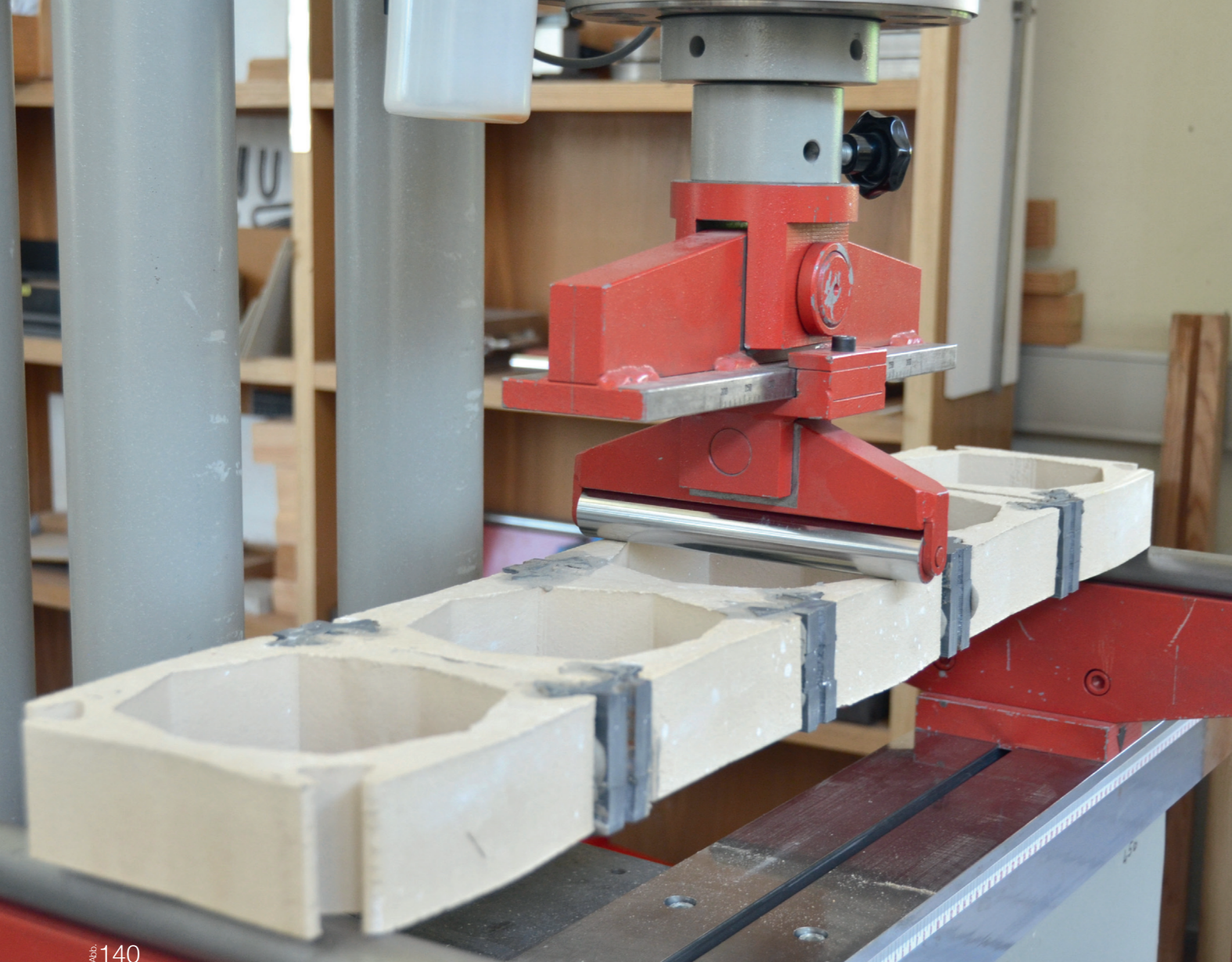
Einzelträger im 3-Punkt-Biegezugversuch #1
