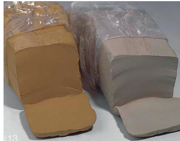
Verschiedene Tonmassen Eisenoxid-Verunreinigungen führen zu Rotfärbungen (links)
