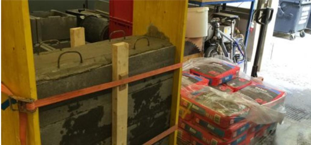
Abb. 121: fertige Mauer mit Kranlaschen – ohne geglätteter Oberfläche
