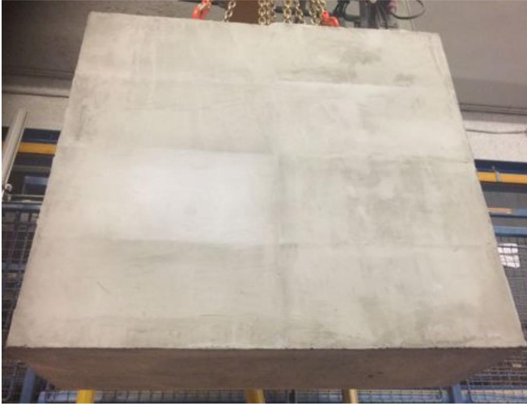
Abb. 123: oberer Teil des Versuchskörpers – mit geglätteter Mauerrück- und -unterseite
