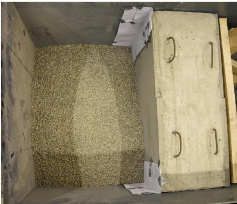
Abb. 129: Versuchskörper bis zur Hälfte hinterfüllt
