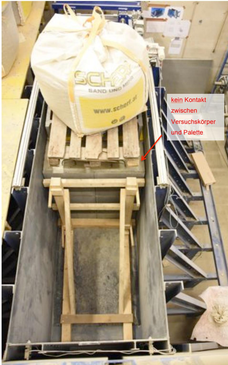
Abb. 130: Versuchskörper mit zusätzlicher Belastung auf der Hinterfüllung
