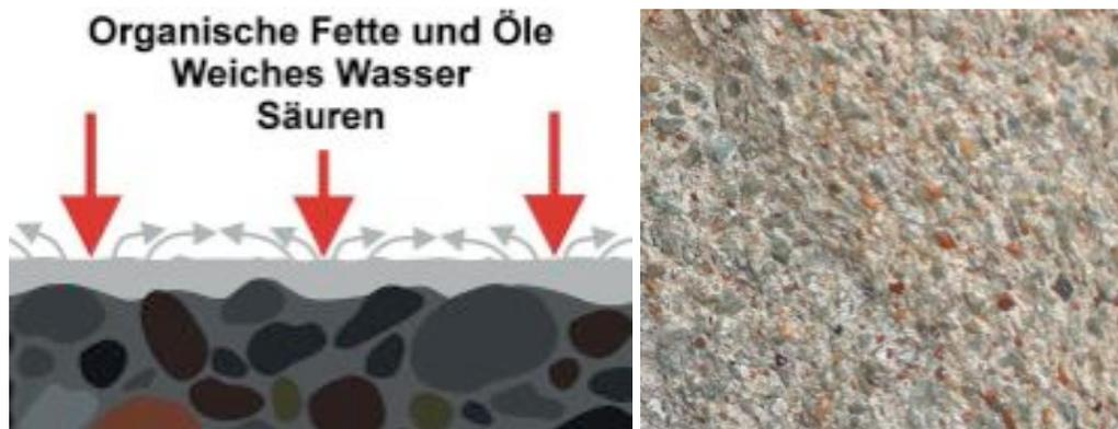
Abb. 78: Links: Schema lösender Angriff. (Weber, 2013); Rechts: Schadensbild Betonkorrosion. (Dolomitreaktor, 2014)
