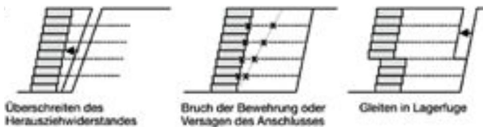
Abb. 69: Innere Versagensmechanismen von Bewehrter Erde (Müller-Kirchenbauer, 2016)
