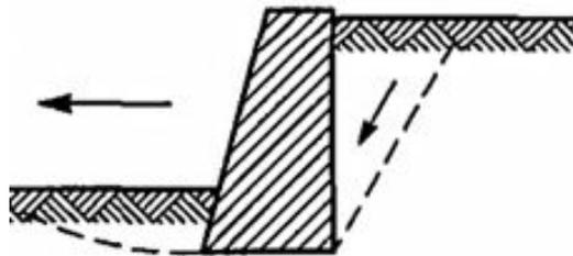
Abb. 65: Versagensmechanismus - Gleiten (ÖNORM EN 1997-1)
