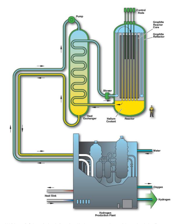
Abbildung 35: Schematischer Aufbau eines Hochtemperaturreaktors mit besonders hoher Temperatur (INL VHTR, 2016)
