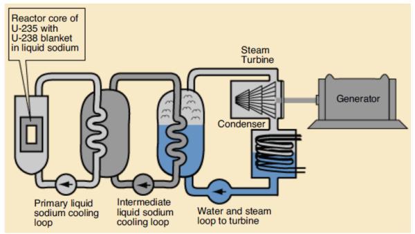
Abbildung 26: Schematischer Aufbau eines Schnellen Brüters (Analytik ETHZ, 2016)
