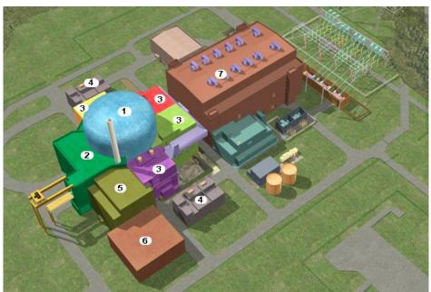
Abbildung 29: EPR Kraftwerksaufbaudesign Schema 2 (AREVA EPR Design, 2016)
