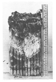
Abbildung 4: Kern des EBR-1 nach der Teilkernschmelze 1955 (Webb, 1976)
