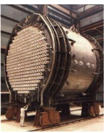
Abbildung 23: CANDU-Reaktorkern (Analytik ETHZ, 2016)
