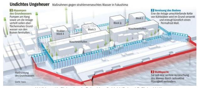
Abbildung 18: Eisbarriere in Fukushima Dai-ichi (Spiegel F. Eisb., 2016)
