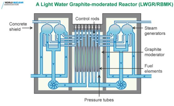
Abbildung 25: Schematischer Aufbau RBMK-Reaktor (world-nuclear RBMK, 2016)
