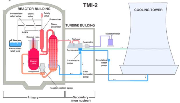
Abbildung 5: Aufbau des Kernkraftwerks TMI-2 (world-nuclear TMI-2, 2016)
