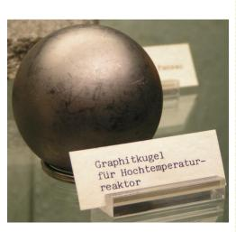
Abbildung 27: Brennstoffkugel für Hochtemperaturreaktor (Analytik ETHZ, 2016)
