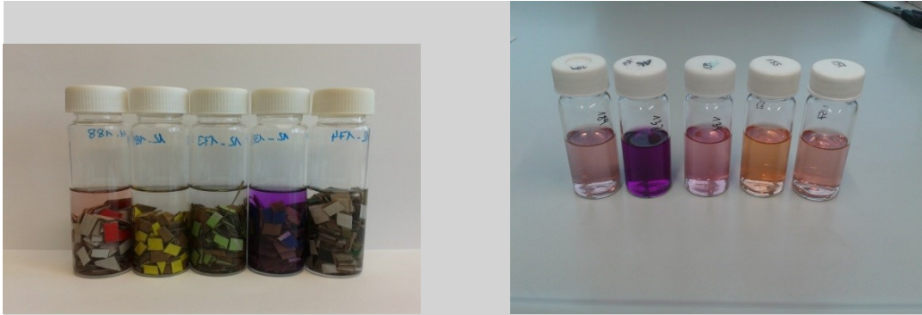
Abbildung 26: Papierproben vor der Extraktion (li.) und filtrierte Extrakte (re.)
