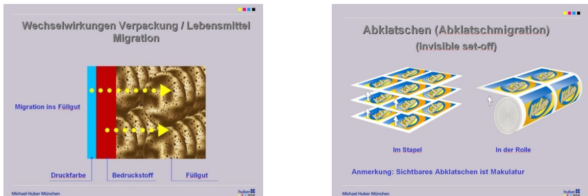
Abbildung 1: Stoffübergang von der Verpackung in das Packgut (Migration und Abklatsch)
