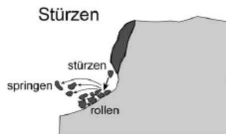
Abbildung 5: Stürzen wird durch eine Teilbewegung im freien Fall charakterisiert (aus ZANGERL ET AL., 2008)
