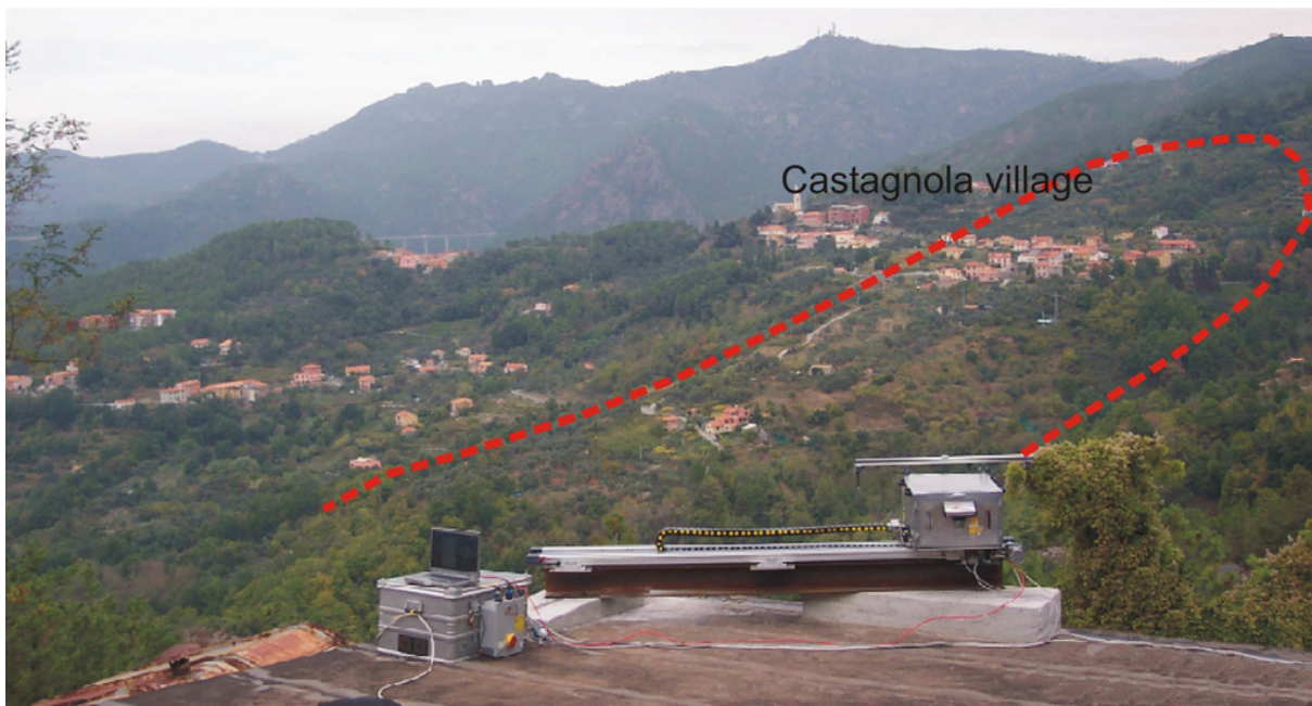
Abbildung 22: Installation eines Ground Based Interferometric Synthetic Aperture Radars (GBInSAR) zur Beobachtung einer Massenbewegung in den Apenninen (Italien). Diese Vorrichtung kann ebenso als protektive Maßnahme dienen und bei einer Grenzwertüberschreitung als Zivilschutzmedium verwendet werden. (Quelle: TOFANI ET AL. (2014); www.mdpi.com )
