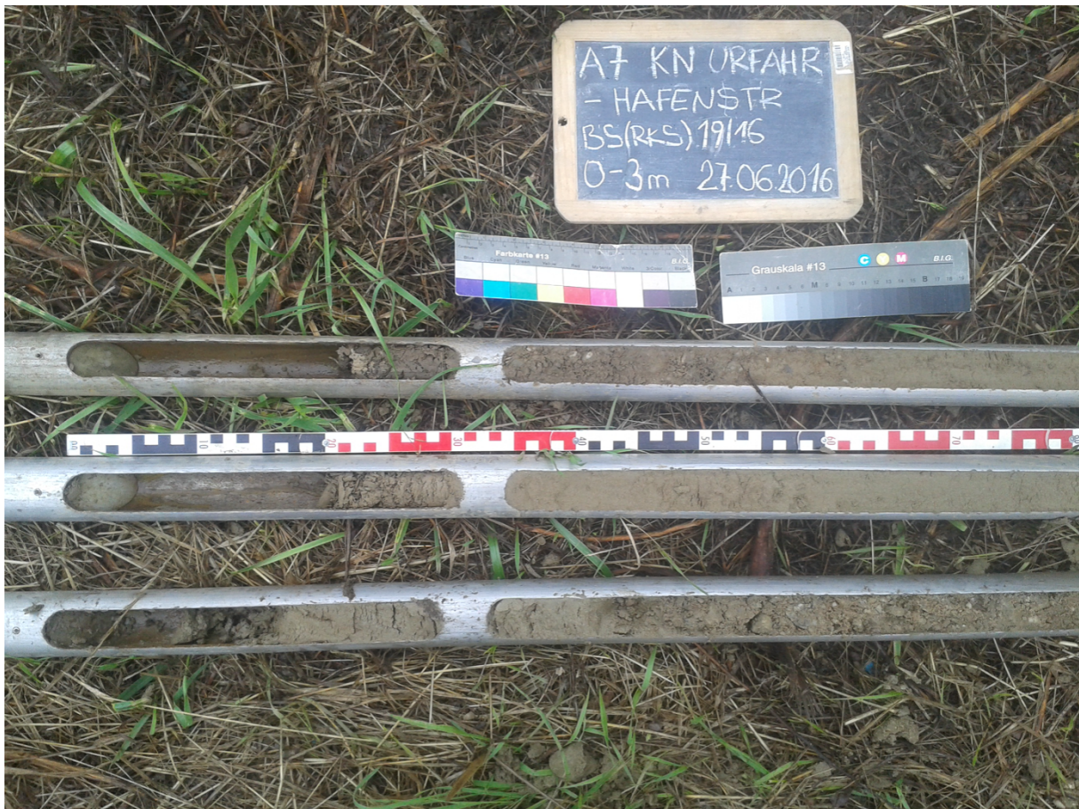
Abbildung 19: Kern der oberen 3 Meter unterhalb der Geländeoberkante aus einer Rammkernsondierung im Zuge einer Baugrunderkundung in der Linzer Hafestraße. (Foto: Ziviltechnik Geologie | Mag. Oliver Montag)
