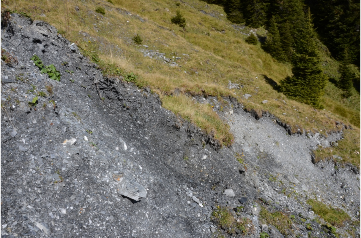
Abbildung 7: In den Abrissbereichen sind neben Graphitphylliten auch Gneise aufgeschlossen, welche eine gröbere Korngröße aufweisen.
