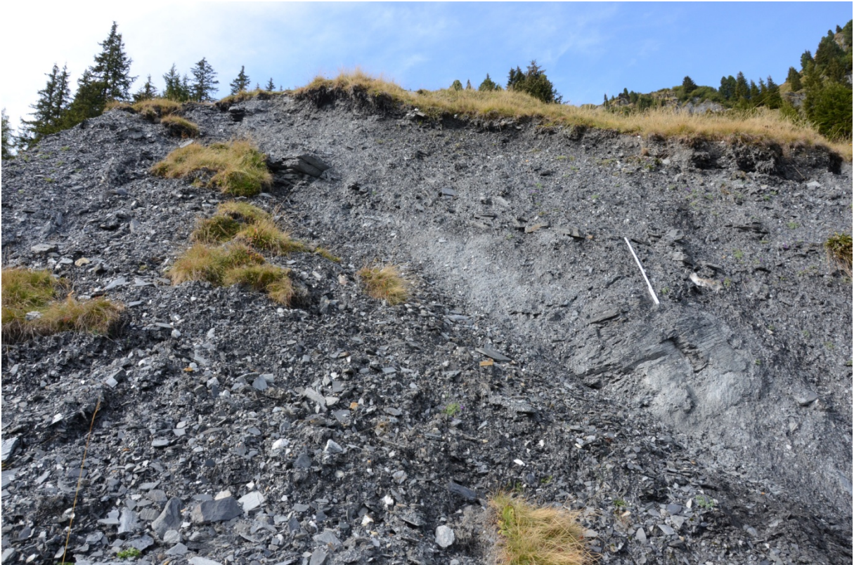
Abbildung 5: Die Materialzusammensetzung umfasst lithologisch hauptsächlich Graphitphyllit; das Korngrößenspektrum reicht von Schluff bis Kies, vereinzelt können auch Steine auftreten.
