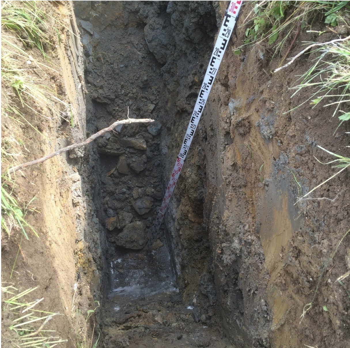
Abbildung 20: Baggerschurf während einer Baugrunderkundung in Steinbach an der Steyr, Oberösterreich. Gut erkennbar sind die einzelnen Schichten (braun-grau) unterhalb des Mutterbodens sowie der anstehende Flysch als Festgestein (grau). Foto: ZT Weichselbaumer
