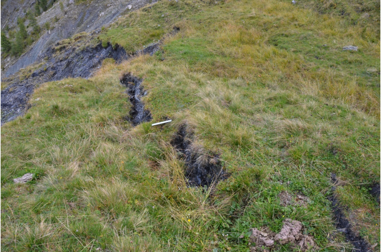
Abbildung 23: Frische Zugklüfte bzw. Dehnungsrisse im weichen Grasbereich als Indiz für eine aktive Bewegung im Untergrund. Die Öffnungsweiten erreichen dabei Ausdehnungen bis mehrere Dezimeter.
