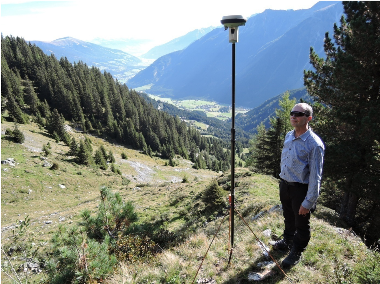
Abbildung 15: Durchführung einer RTK-GPS Vermessung im Gelände in Krimml, Salzburg. Foto: Kaufmann
