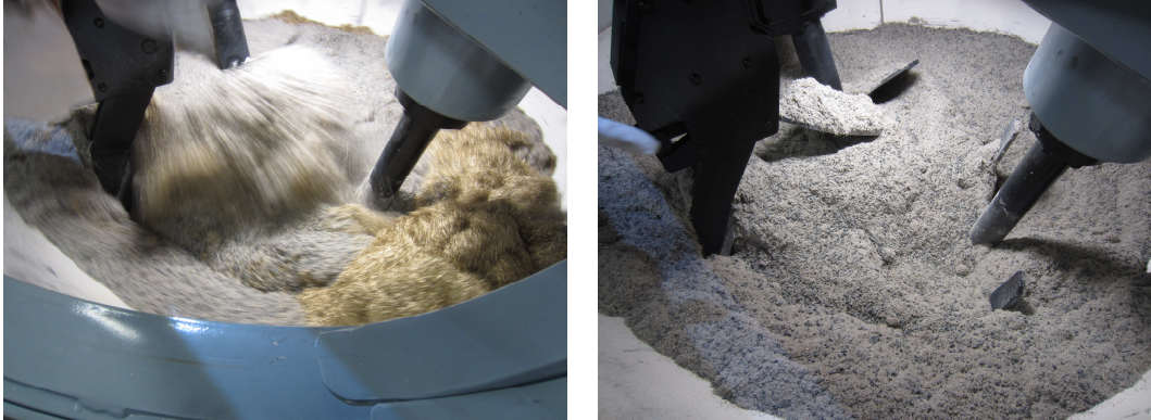
Abbildung 60 Einmischen der Stahlfasern in die F 45-Rezeptur (links) und fertige Trockenmischung der Grobkorn-Premix für die F 45-Rezeptur (rechts)
