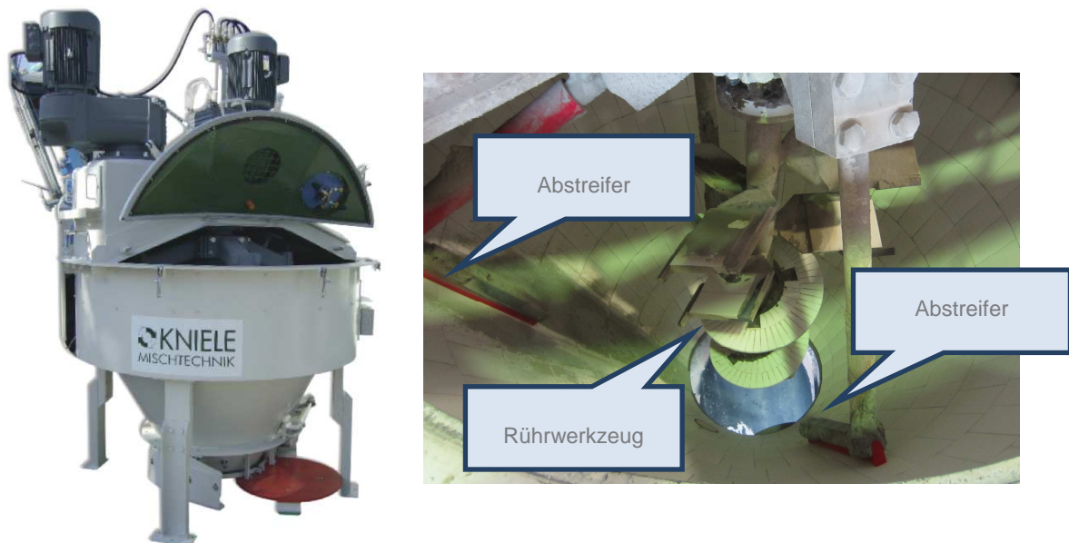
Abbildung 50 Kniele Konusmischer [82] (links) und Blick in den Mischertrog (rechts)
