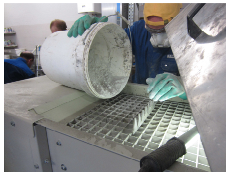
Abbildung 85 Beschickung des Mischers mit den Feststoffpartikeln
