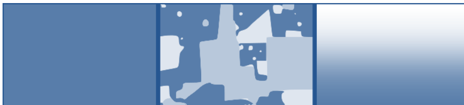
Abbildung 12 Schematische Darstellung von Homogenität, Heterogenität und Inhomogenität (von links nach rechts) [29]
