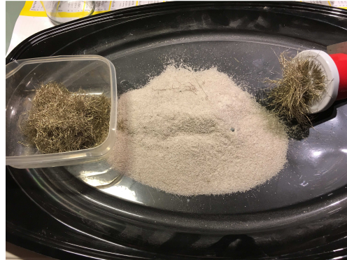
Abbildung 71 Trennung der Stahlfasern mittels Magneten
