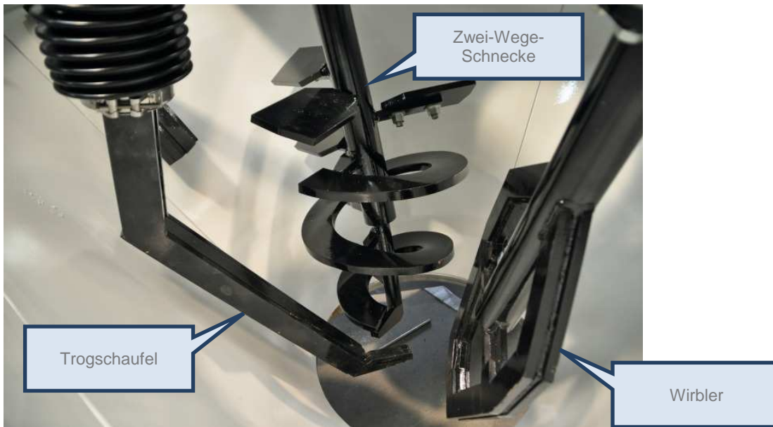
Abbildung 46 Mischwerkzeuge des Skako Rotoconix
