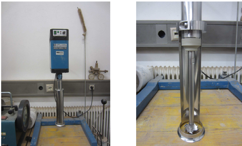
Abbildung 95 Ultra Turrax T50 (links) und Mischwerkzeug (rechts)
