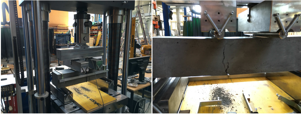
Abbildung 69 Versuchsordnung und Risswachstum des Prüfkörpers
