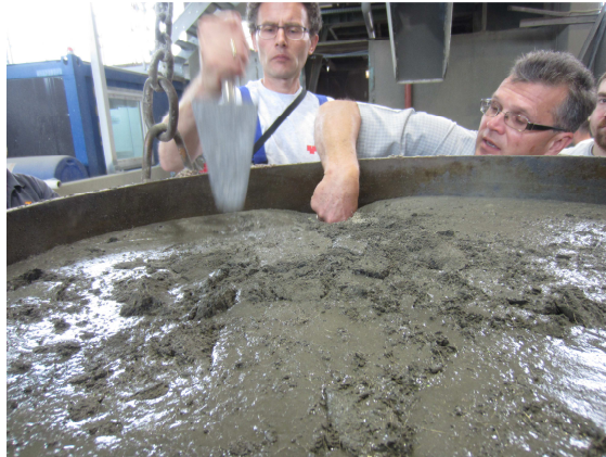
Abbildung 84 Kontrolle der "Frischbetoneigenschaften"
