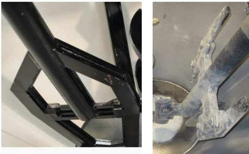
Abbildung 49 Varianten des Hochgeschwindigkeitswirblers beim Skako Rotoconix (links Variante A: Standardwirbler - rechts Variante B: Spezialwirbler)
