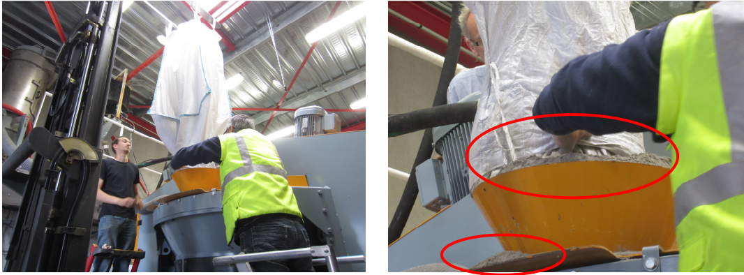
Abbildung 63 Einfüllen des „Bindemittel-Feinkorn-Big-Bags“ (links) und Rückstau und Verlust der Premix beim Einfüllen (rechts)
