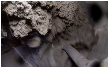
„Aufschaukeln“ des Materials bei der ruhenden Schnecke
