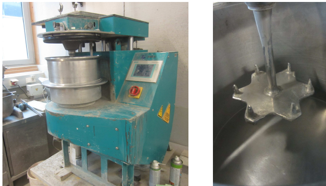
Abbildung 93 Eirich-Labormischer (links) und das verwendete Mischwerkzeug (rechts)
