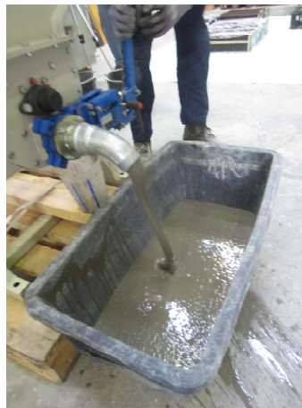
Abbildung 89 Herstellen der Bindemittelsuspension-Blick in den Mischertrog (links) und Entleerung der Bindemittelsuspension (rechts)
