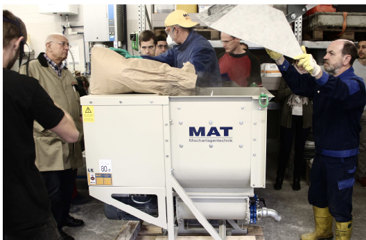
Abbildung 85 Beschickung des Mischers mit den Feststoffpartikeln
