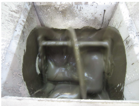
Abbildung 89 Herstellen der Bindemittelsuspension-Blick in den Mischertrog (links) und Entleerung der Bindemittelsuspension (rechts)
