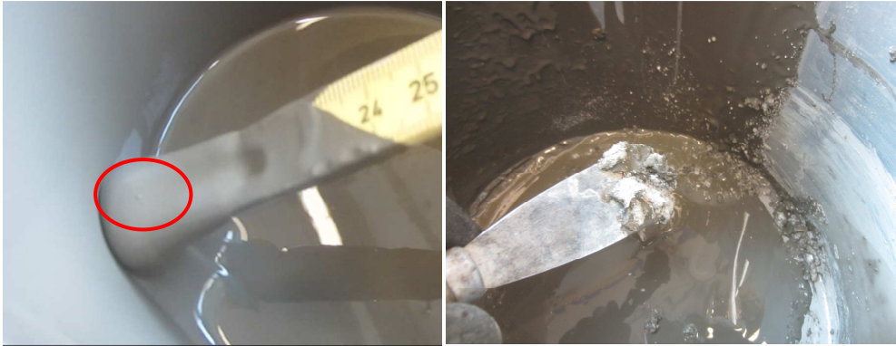
Abbildung 94 Partikelzusammenschluss (links) und nicht eingemischtes Material (rechts)
