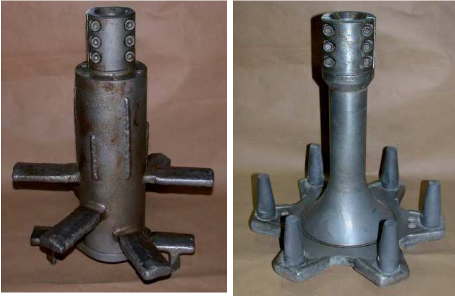
Abbildung 56 Sternwirbler (links) und Stiftenwirbler (rechts) [61]
