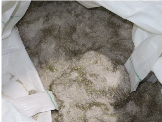
Abbildung 82 Blick in den „Stahlfaser-Grobkorn-Big-Bag“
