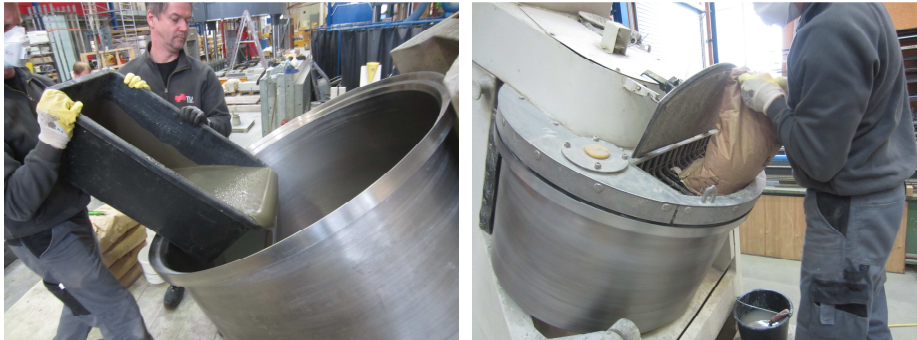
Abbildung 90 Beschickung des Eirich-Intensivmischers mit der Bindemittelsuspension (links) und mit den Grobkornzuschlägen (rechts)
