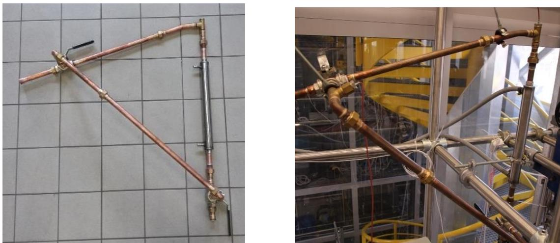
Abb. 6-12: Gepackte Kolonne und Geistrohr; links: vor dem Einbau; rechts: nach dem Einbau
