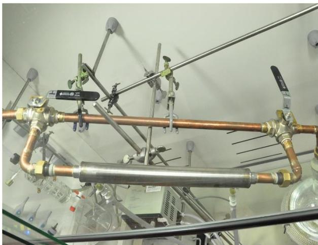
Abb. 6-10: Geistrohr und gepackte Kolonne mit 3-Wege-Hähne
