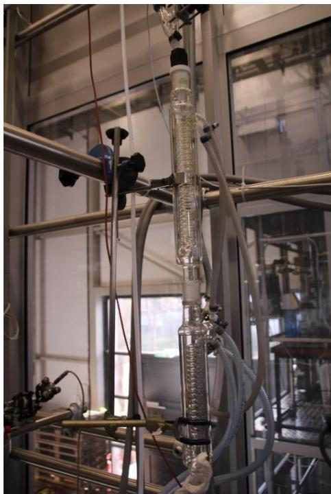
Abb. 6-7: Kopfkondensator
