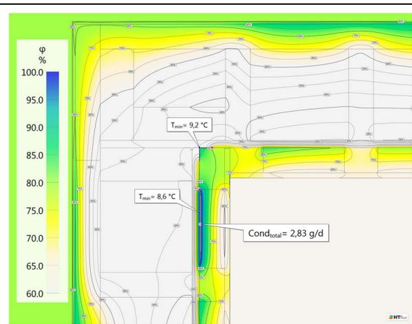
Abb. 188: D220-9-0; ohne Gefachdämmung, Feuchteverteilung [KK]
