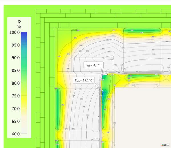
Abb. 171: D240-9-0; vertikale UK; Feuchteverteilung [KK]
