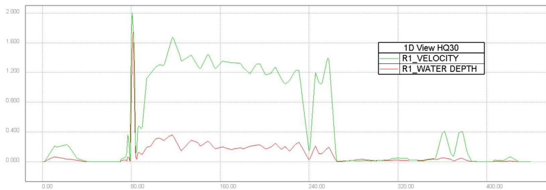
Abbildung 42 Überströmhöhen in [m] und Fließgeschwindigkeiten in [m/s], von der Mur in das Umland, entlang der überströmten Strecke R1 bei HQ 30
