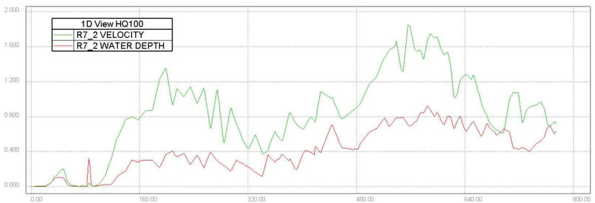
Abbildung 87 Überströmhöhen in [m] und Fließgeschwindigkeiten in [m/s], von der Mur in das Umland, entlang der überströmten Strecke R7_2 bei HQ 100
