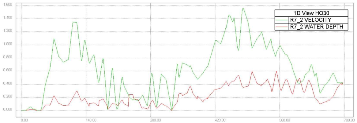
Abbildung 84 Überströmhöhen in [m] und Fließgeschwindigkeiten in [m/s], von der Mur in das Umland, entlang der überströmten Strecke R7_2 bei HQ 30
