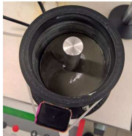
Abb. 64 seitliches Umfließen der Suspension
