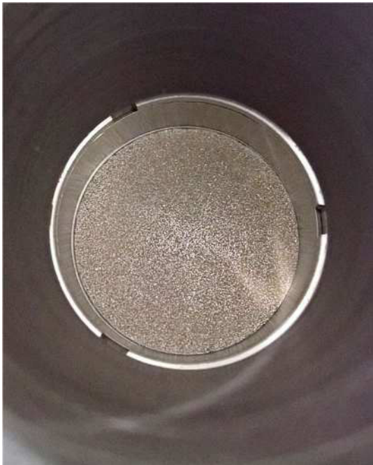
Abb. 34 Innenansicht des Aufsatzzylinders montiert auf der Ödometerzelle
