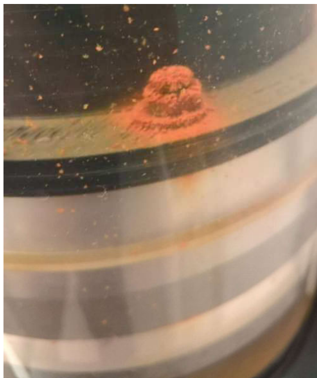
Abb. 62 Bimetallkorrosion zw. Befestigungsmaterial und Ödometerzelle
