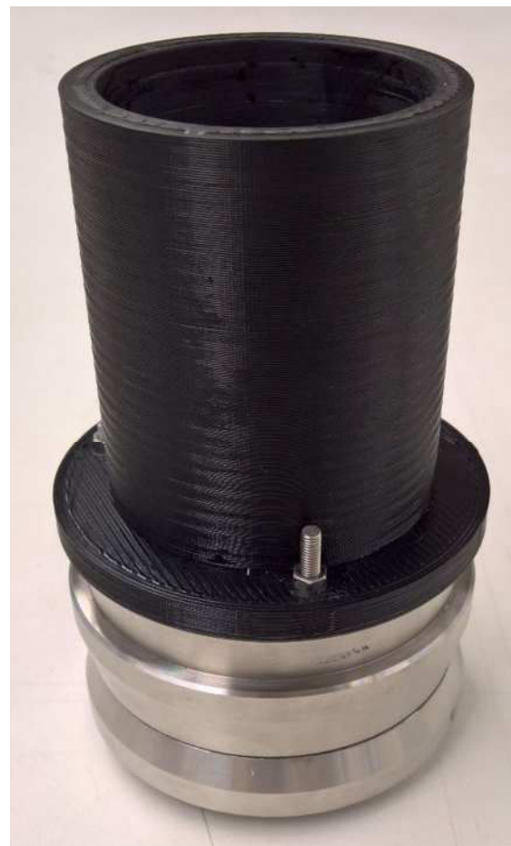
Abb. 19 Aufsatzzylinder auf der Ödometerzelle montiert
