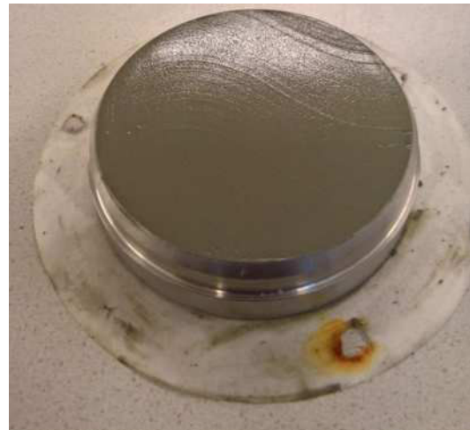
Abb. 42 fertige SD Ödometerprobe
