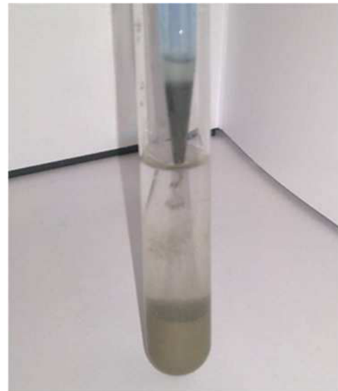
Abb. 48 Sand wird drucklos eingeriesel
