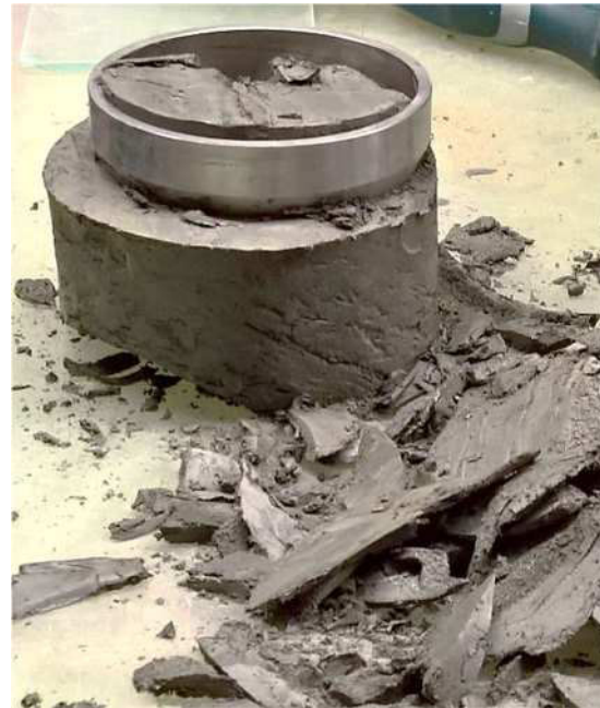
Abb. 25 Entnahme einer ungestörten Ödometerprobe (GIN_0,80-1,20_SD.1)
