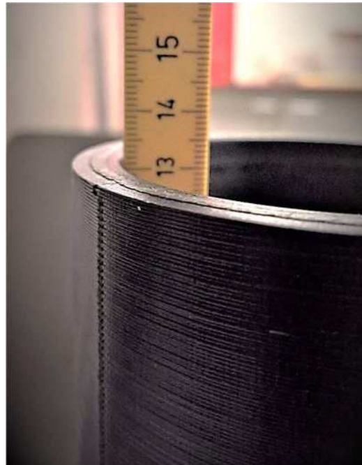
Abb. 34 Innenansicht des Aufsatzzylinders montiert auf der Ödometerzelle
