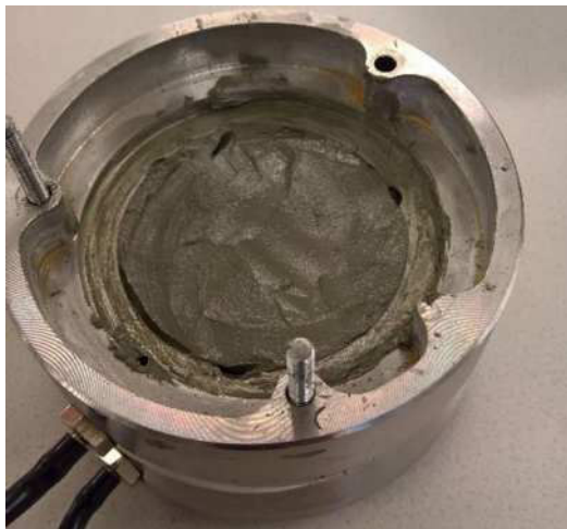
Abb. 41 schrittweises Entfernen der überschüssigen SD Probe (2)
