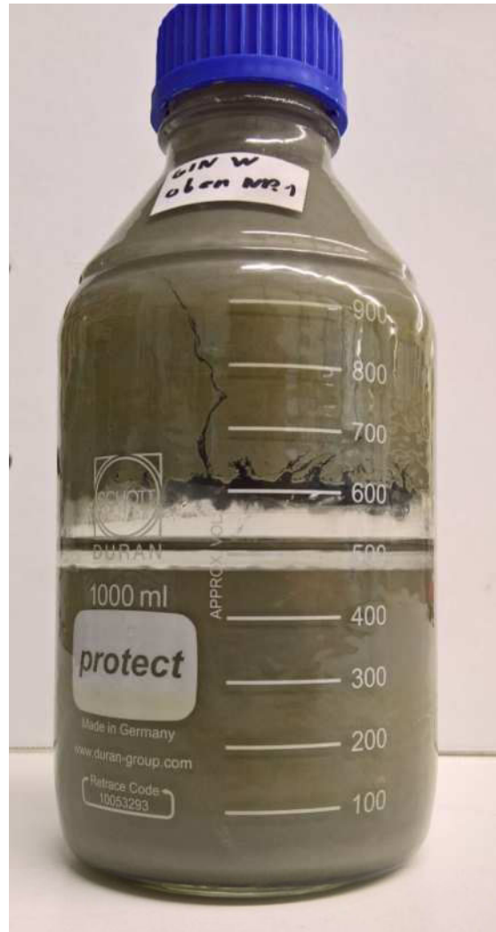
Abb. 33 überschüssiges Wasser nach dem Absetzprozess
