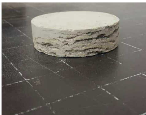
Abb. 30 getrocknete Ödometerprobe GIN_090-1,30_NP.1
