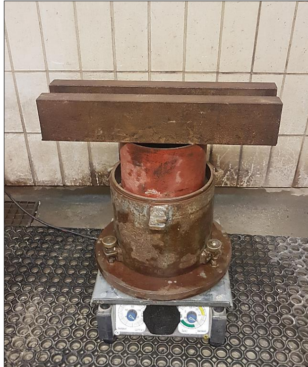
Abb. 30: Probenverdichtung mittels Rütteltisch nach DIN 18126:1996
