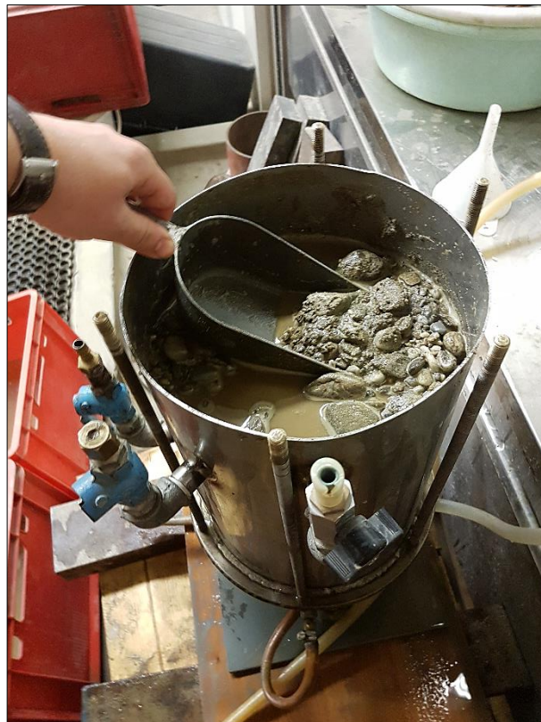
Abb. 36: Lagenweiser Probenausbau aus dem Zylinder nach beendeter Durchströmung (drei separate Bereiche: unterste, mittlere, oberste Schicht)
