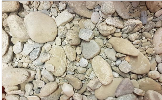
Abb. 49: Versuchsprobe 3 (co“ si‘ Gr): Murschotter mit künstlicher Ausfallkörnung im Korngrößenbereich 0,125 bis 4 mm
