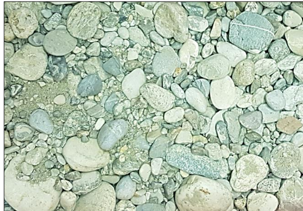
Abb. 44: Versuchsprobe 2 (co' sa' Gr): Murschotter mit reduzierter Körnung \leq 2 mm
