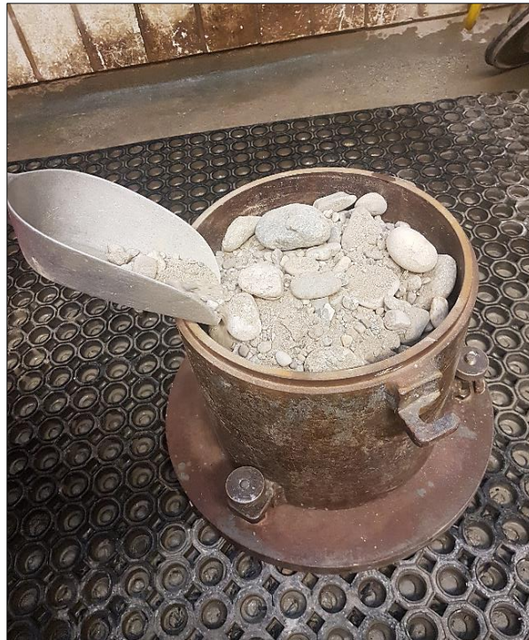
Abb. 29: Lockerster Lagerungseinbau mittels Handschaufel nach DIN 18126:1996
