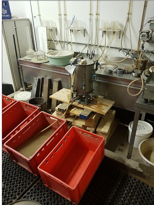
Abb. 35: Versuchsaufbau zur Ermittlung der Suffusionsstabilität auf Basis eines adaptierten Durchlässigkeitsversuchs
