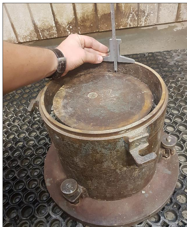
Abb. 31: Abstandsmessung mittels Schublehre zur Ermittlung der Probensetzung an sechs im Umfang von 60^\circ versetzten Punkten
