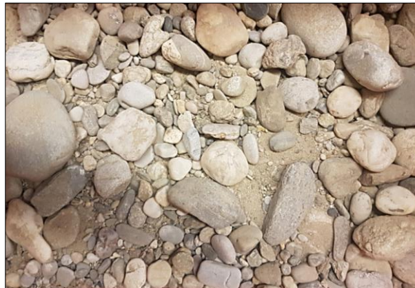
Abb. 37: Versuchsprobe 1 (si“ sa Gr): Murschotter
