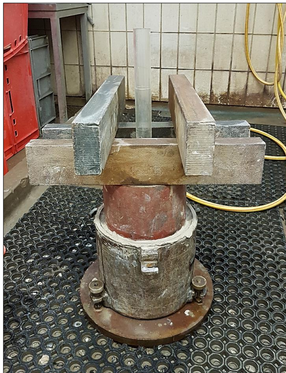
Abb. 33: Realisierte Standrohrmessung zur Bestimmung der Probendurchlässigkeit
