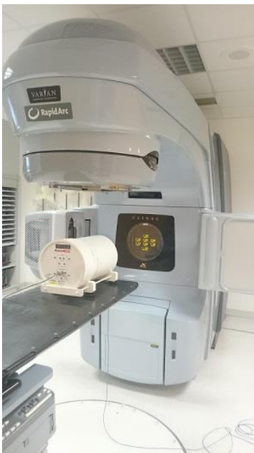
Abbildung 11: Messaufbau mit Linac® iX und Messphantom ArcCHECK®.
