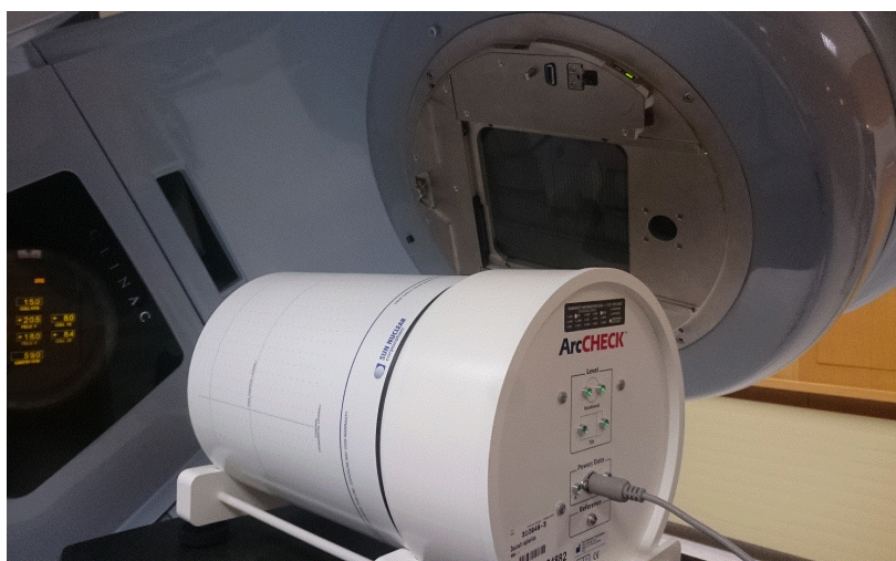
Abbildung 1: ArcCHECK® Messphantom Kollimator des Typs Millennium 120.
