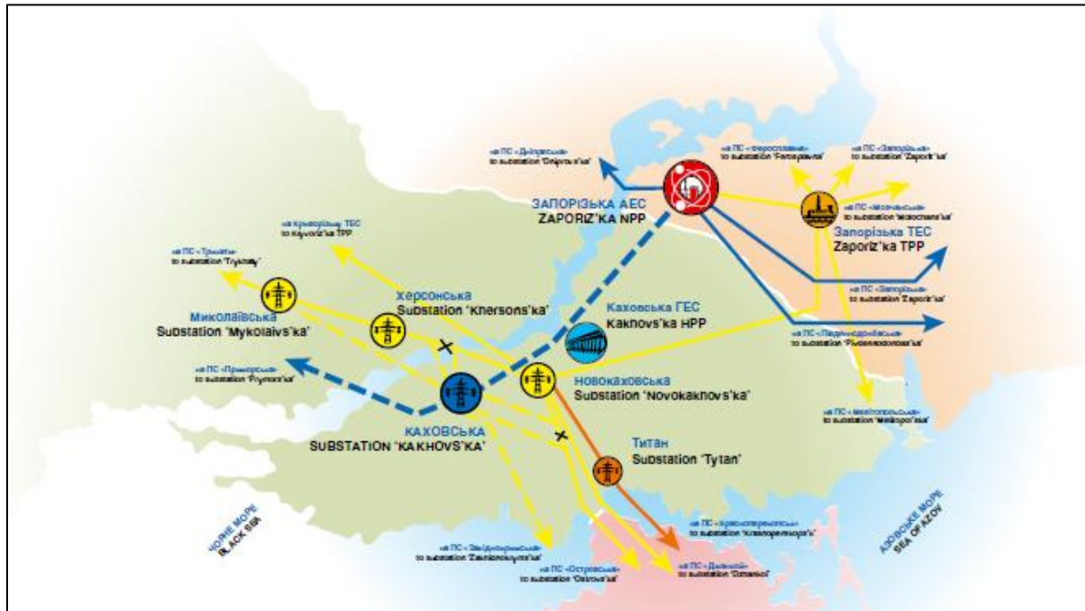
Abbildung 53: Geplante 750kV Leitung LTGUA210 124
