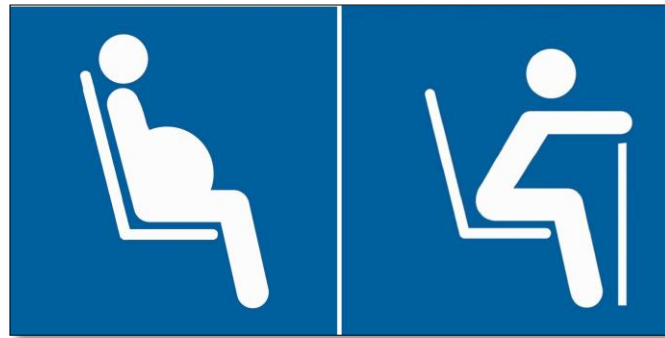
Abbildung 2 Die Zeichen für Menschen mit Behinderungen und Menschen mit eingeschränkter Mobilität gemäß Anlage N (QUELLE: Europäische Eisenbahnagentur; (EU) Nr.1300/2014 „Zugänglichkeit für Menschen mit Behinderung und Menschen mit eingeschränkter Mobilität (PRM)“ Anlage N; 12.Dezember 2014) [1]
