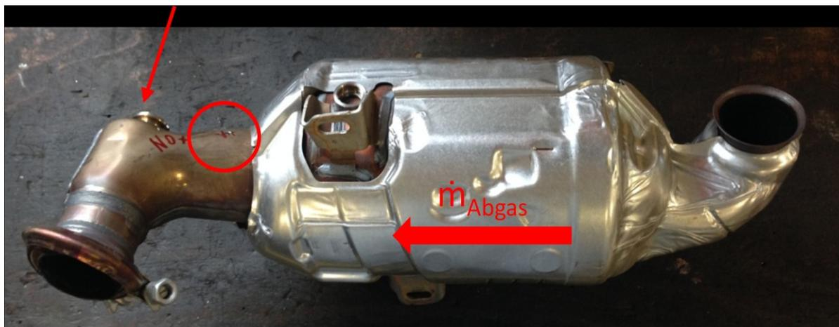
Abbildung 3-2: DOC im ausgebauten Zustand
