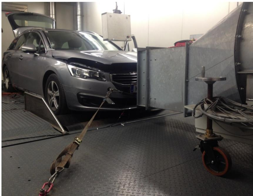
Abbildung 3-13: Fahrzeugaufbau am Prüfstand
