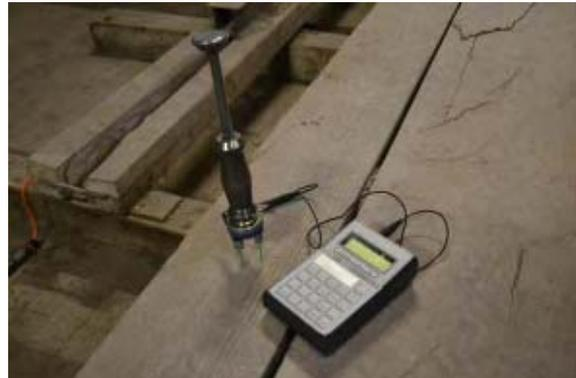
**Abb. 5.93:** *Verwendetes Holzfeuchtemessgerät GANN M4050 mit Rammelektrode M18*
