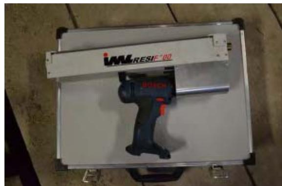
**Abb. 5.94:** *Verwendetes Bohrwiderstandsmessgerät IML Resi F300*
