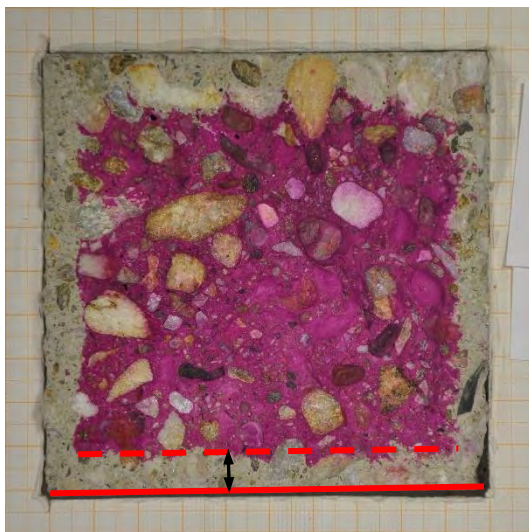
Abbildung 9 Messung mittels Indikatorlösung
