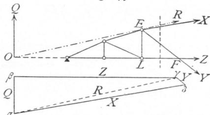
$Q$  und die 3 unbekanntenen Spannungen der durch den Schnitt getroffenen Stäbe. Für diese 4 Kräfte ergibt sich ein geschlossenes Kraftpolygon. Von einer dieser Kräfte, nämlich von  $Q$ , ist Grösse, Richtung und Lage bekannt; von den drei anderen wohl die Richtung und Lage, nicht aber die Grösse. Ersetzt man 2 der unbekanntenen Kräfte, etwa  $X$  und  $Y$ , durch ihre Mittelkraft  $R$ , so bleiben
