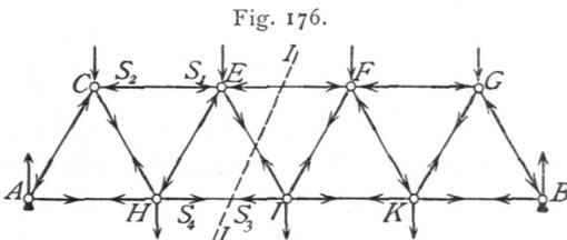
Stabe  $CE$  (Fig. 176) wird von  $C$  eine Kraft  $S_1$  auf  $E$  übertragen, und eine gleich große Kraft  $S_2$  von  $E$  auf  $C$ ; beide sind Druck. In  $HI$  wird von  $H$  auf  $I$  ein Zug  $S_3$ , von  $I$  auf  $H$  ein gleich großer Zug  $S_4$  ausgeübt. In Fig. 176 sind alle auf die Knotenpunkte wirkenden Stabspannungen angegeben.
