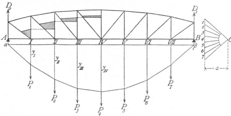
Sollen die Ausdrücke  $\frac{M}{a}$  für die einzelnen Knotenpunkte rechnerisch bestimmt werden, so führt man zweckmäßig die Feldweite  $a$  als Einheit ein. Sind in Fig. 184 alle Knotenpunktlasten gleich  $P$ , so wird
