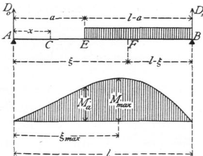
Die Belastung nach Fig. 159 kommt im Hochbau sehr häufig vor, z. B. bei Trägern unter Mauern, in welchen sich Fenster- oder Thüröffnungen befinden. Für die Querschnittsbemessung ist das größte Moment maßgebend, welches demnach aufgesucht werden soll.
