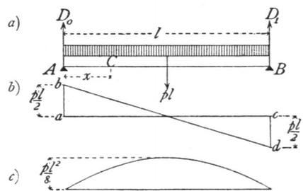
Die Belastung für die Längeneinheit des Trägers (Fig. 158) sei  $p$ ; alsdann ist die Mittelkraft gleich der Gesamtlast, also gleich  $p l$  und greift in der Trägermitte an. Die Gleichung der statischen Momente für  $B$  als Drehpunkt heißt demnach:
