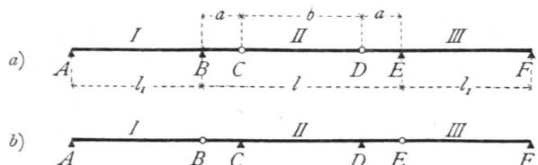
in Fig. 168 *b*, jederfeits ein Kragftück *BC*, bezw. *DE*, und die Seitenträger *AB* und *EF* ruhen einerfeits auf den Endftützpunkten *A*, bezw. *F*, andererseits auf den Enden *B* und *E* der erwähnten Kragftücke.
