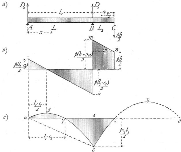
$M_{x_1} = -\frac{p}{2}(a b + a^2) = -\frac{p}{2} c_1 l_1$ , wie bereits oben gefunden. Hiernach ist die Parabel  $\delta \zeta \eta \vartheta$  in Fig. 170c construiert.
