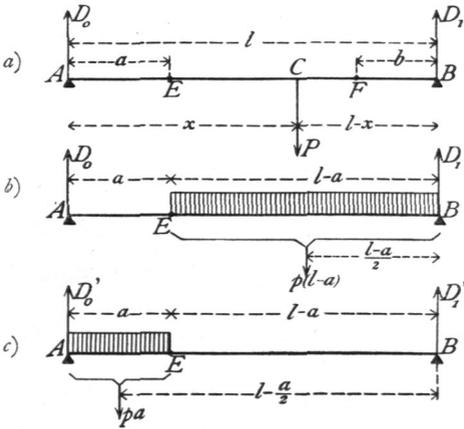
Man erhält die Werthe von  $Q_{max}$ , bezw.  $Q_{min}$  für den Querschnitt  $E$ , welcher um  $a$  vom linken Auflager entfernt liegt, und für die Belastung  $p$  auf das laufende Meter, wie
