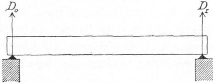
1) Balkenträger, d. h. Träger, auf welche bei lothrechten Belastungen nur lothrechte Stützendrücke wirken. Fig. 152 zeigt einen Balkenträger;  $D_0$  und  $D_1$  sind die Auflagerdrücke.
