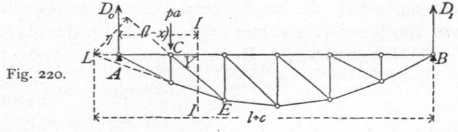
Die Gleichungen 253 u. 254 gelten, wenn die Diagonalen, wie hier, nach rechts fallen, nur für diejenigen links der Mitte; für die Diagonalen rechts der Mitte, bei denen der Momentenpunkt rechts von  $B$  fällt, ergeben sich folgende Werthe, in denen  $\eta_1$  den Hebelsarm von  $Y$ ,  $c_2$  den Abstand des Momentenpunktes von  $B$  bedeutet:
