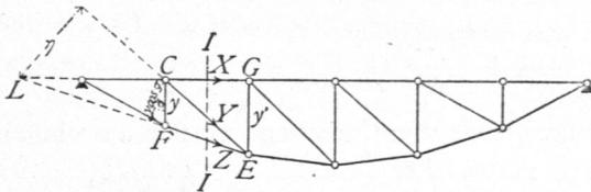
Für einen Stab  $CG$  der oberen Gurtung ist  $E$  der conjugirte Punkt, und wenn das Moment der äußeren Kräfte für diesen Punkt mit  $M'$  bezeichnet wird,
