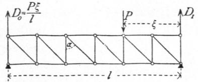
c) Wenn der Träger durch eine Einzellaft belastet wird (Fig. 204), so erhält jede Diagonale zwischen dem Lastpunkt und dem linken Auflager, nach welchem hier die Diagonalen steigen, einen Zug
