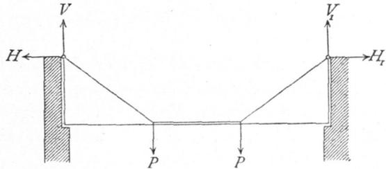
Für den Hochbau sind die Balkenträger die weitaus wichtigsten; die Sprengwerks- und Hängewerksträger werden im Hochbau nicht gern angewendet, weil die Mauern, welche die Stützpunkte der Träger bilden, bei diesen Trägerarten wagrechte Kräfte zu erleiden haben, wodurch eine große Mauerstärke bedingt wird.
