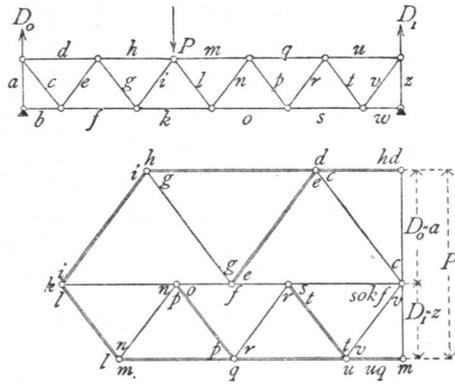
Für eine Einzellaft wird die Ermittlung der Spannungen bequem mittels des *Cremona'schen* Kräfteplans vorgenommen, wie in Fig. 197 gefchehen ist; dieselbe ist ohne Weiteres verständlich.
