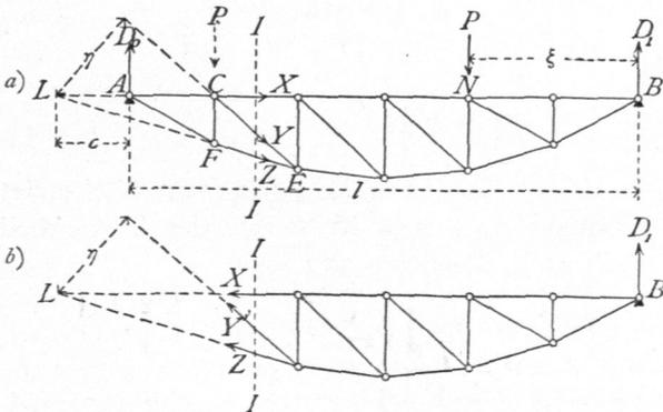
Gitterstäbe. Die ungünstigste Belastung für eine Diagonale  $CE$  (Fig. 218) wird folgendermaßen erhalten. Eine rechts von dem durch die Diagonale verlaufenden Schnitte  $II$  gelegene Last  $P$  erzeugt in  $A$  den Auflagedruck  $D_0 = \frac{P \xi}{l}$  und in  $CE$  eine Diagonalfpannung  $Y$ , welche aus der Momentengleichung für Punkt  $L$  und das links vom Schnitte liegende Bruchstück folgt:
