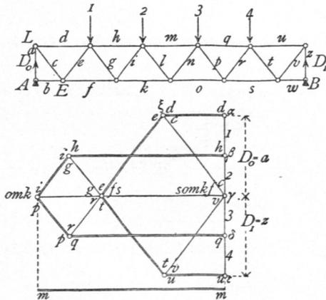
die Belaftung  $g a$ , bzw.  $p a$  wirkt, so empfiehlt sich für die Ermittlung der Spannungen die Vieleckmethode, weil dieselbe sämtliche Stabspannungen in einem Linienzuge giebt.
