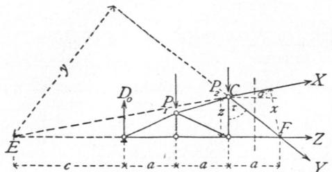
Man lege durch den Träger einen Schnitt, so daß nur 3 Stäbe mit unbekanntem Spannungen geschnitten werden, bringe diese Spannungen und alle am Bruchstück wirkenden äußeren Kräfte an, setze die algebraische Summe der statischen Momente dieser Kräfte gleich Null und
