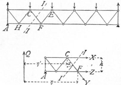
a) Das Eigengewicht der Construction kann als eine gleichmäßig über die Länge des Trägers vertheilte Belastung angesehen werden. Wir bezeichnen es mit  $g$  für die Längeneinheit und machen die vereinfachende Annahme, daß alle Belastungen
