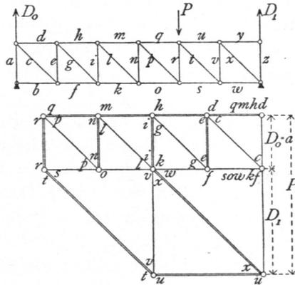
Die oben stehende Curve (Fig. 206) ergibt demnach die Werthe für  $Q_{max}$ , so wie  $Q_{min}$  und damit, wie gezeichnet, leicht die Werthe für  $Y$  und  $V$ . Der für  $V_{3min}$  angegebene Werth entspricht einer Belastung der oberen Gurtung.
