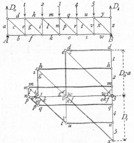
Wenn die Zeichnung für eine Belastung  $g$  auf die Längeneinheit construirt ist, so geben die Längen der einzelnen Linien auch zugleich die Beanspruchungen für die Belastung  $p$  auf die Längeneinheit, falls dieselben nur auf einem Maßstabe abgegriffen werden, auf welchem diejenige Länge  $p a$  bedeutet, welche vorher  $g a$  bedeutet hatte.
