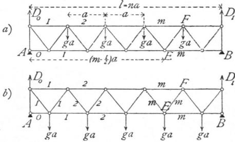
Felderzahl des Trägers  $n$ , mithin  $l = n a$ . Jeder Mittenknotenpunkt ist mit  $g a$  belastet; die Belastungen der Knotenpunkte über den Auflagern berücksichtigen wir nicht, weil diese unmittelbar von den Auflagern aufgenommen werden.
