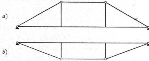
Gurtung zeigt eine gerade, die andere eine gebrochene Linie. Ist die untere Gurtung gerade, so erhält man die unter dem Namen des einfachen, bezw. doppelten Hängebockes bekannte Trägerform (Fig. 227a, bezw. 228a) — nicht zu verwechseln mit den Hängewerkträgern, welche nach Art. 148 (S. 125) von der hier betrachteten wesentlich verschieden sind. Ist die obere Gurtung gerade, so erhält man die unter dem Namen des armierten Balkens bekannte Trägeranordnung (Fig. 227b u. 228b).
