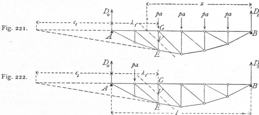
erzeugt und umgekehrt. Es wird also größter Druck in  $GE$  bei der in Fig. 221 gezeichneten Belastung, größter Zug bei der in Fig. 222 gezeichneten Belastung stattfinden.
