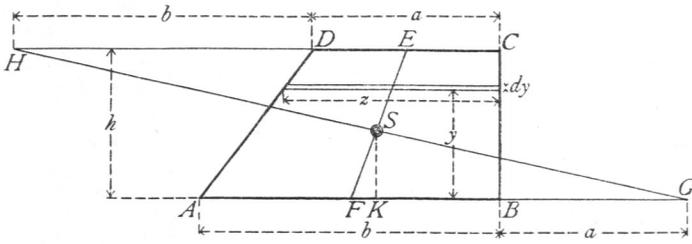
Der Schwerpunkt des Trapezes in Fig. 27 liegt auf der Verbindungslinie der beiden Punkte E und F, welche die beiden parallelen Seiten halbiren. Ferner ist
