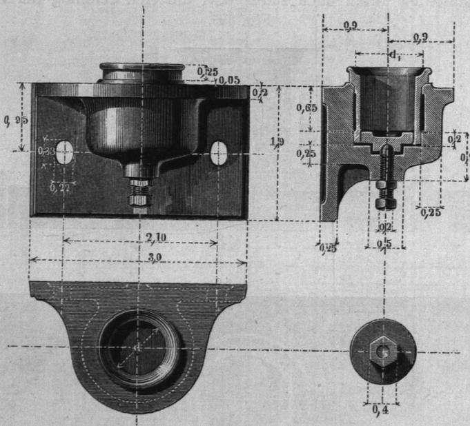
einen untergelegten Keil zu stützen, den man  $0,8 d_1$  hoch mache, um nach seiner Wegnahme das Lager unter dem Zapfen wegziehen zu können, ohne letzteren aus seiner Lage bringen zu müssen. Die Ausnehmung in der Spurplatte dient sehr gut als Oelkammer; die Abnutzung normal auf die Zapfenstirn kann durch Nachdrehen der Stellschraube bequem ausgeglichen werden.
