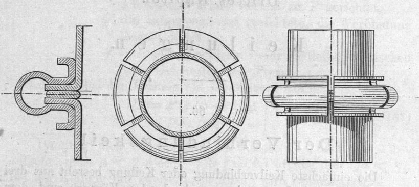
zwängen die schwach vorspringenden Flantschen zusammen, und zwar werden sie mittelst einer Schraubzange aufgesetzt oder abgenommen. Proben an Dampf- und Luftleitungen (bei pneumatischen Pfeilergründungen) und solche mit der hydraulischen Presse haben die Verbindung als bewährt erwiesen.
