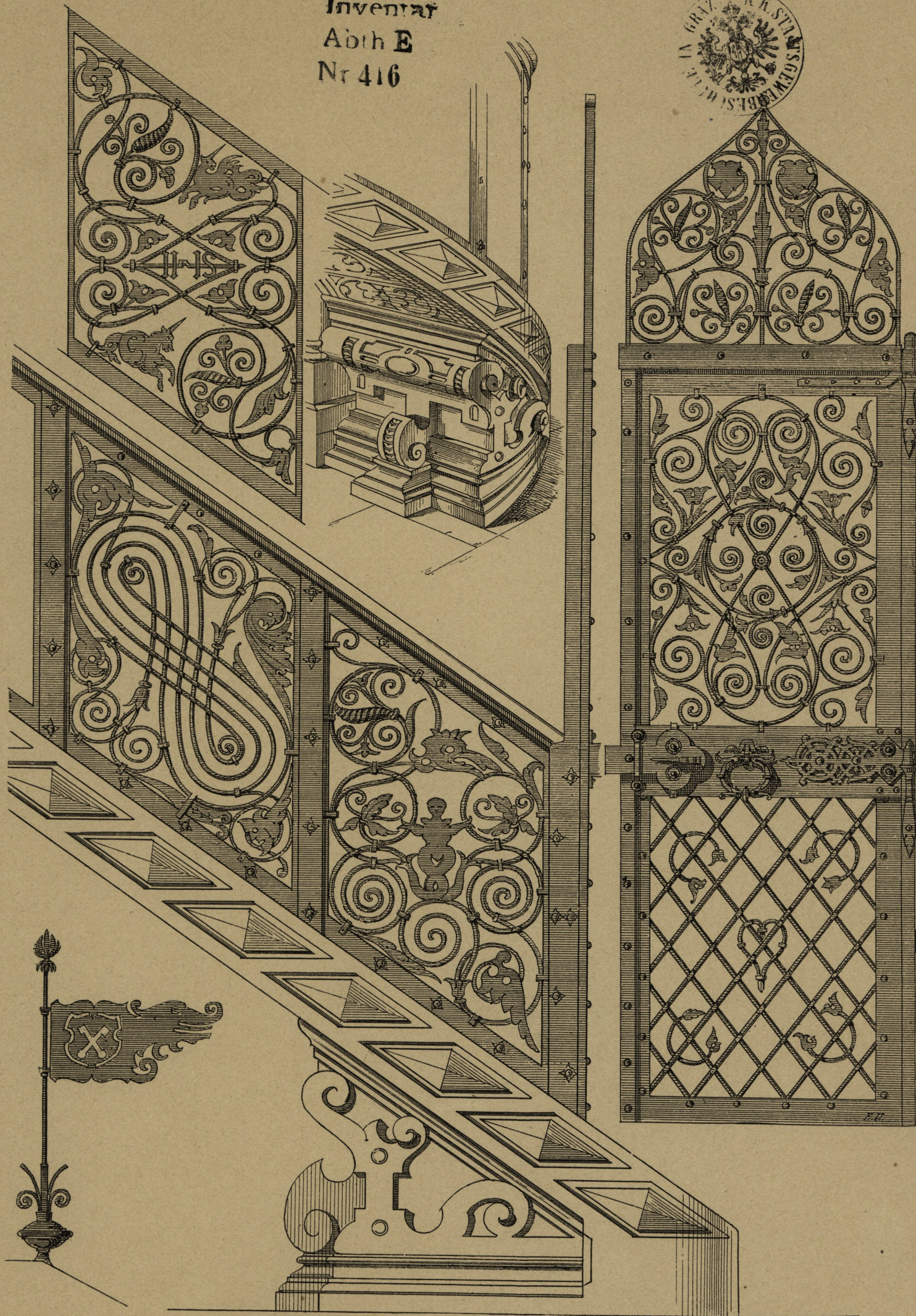
Details der Kanzeltreppe im Münster zu Thann im Elsass (16. Jahrhundert) und Wetterfahne aus Lich bei Giessen; in \frac{1}{10} der wirklichen Grösse.
