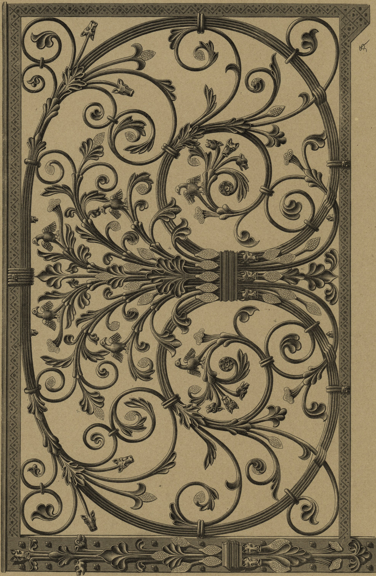
Füllung vom Communion-Gitter der Kathedrale zu Verdun, aus einem Stück geschmiedet von Schlossermeister A. G. Moreau in Paris.
