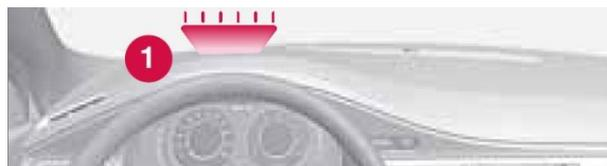
**Abbildung 4.7:** Optische Frontalkollisionswarnung im Volvo S80, Modelljahr 2011 [Vol10]:
