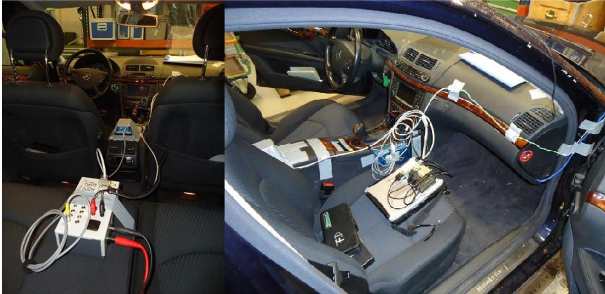
**Abbildung 6.1:** Messtechnik in Fzg. A: links Stromversorgung und IMU an der Mittelkonsole befestigt, rechts Stromversorgung, Datenlogger und Messrechner
