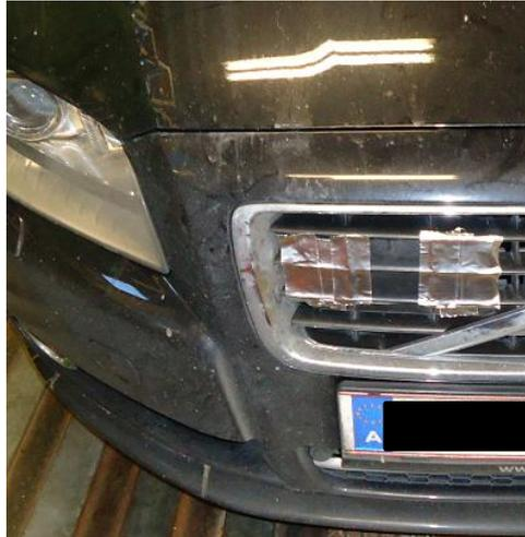
**Abbildung 6.2:** Radarsensor des Fzg. B teilweise mit Aluminiumklebeband abgeklebt
