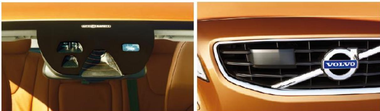
**Abbildung 4.12:** Kamera im Bereich des Innenspiegels an der Windschutzscheibe im Wischbereich des Scheibenwischers, Radarsensor hinter dem Kühlergrill im Volvo S60 [VKU11]
