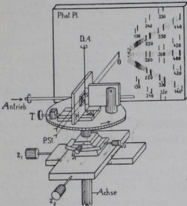
Fig. 570. Aufnahmeeinrichtung für Dreh-spektrogramme.
