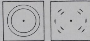
Fig. 571. Debye-Scherrer- und Polanyi-Diagramm.
