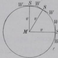
Fig. 454. Strahlengeschwindigkeits- und Normalenfläche eines isotropen Stoffes.
