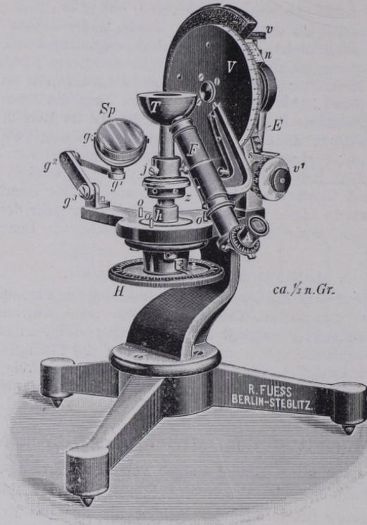
Fig. 373. Refraktometer nach Pulfrich. *T* Glashalbkugel, *F* Fernrohr zum Ablesen der Totalreflexionsgrenze mittels Teilkreises *V*, *Sp* Beleuchtungsspiegel, *H* Teilkreis für die Drehung der Platte in ihrer Ebene.
