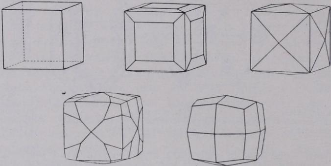
Fig. 293/97. Lösungserscheinungen an einem Steinsalzwürfel in untersättigter harnstoffhaltiger Kochsalzlösung. Nach W. Schnorr.
