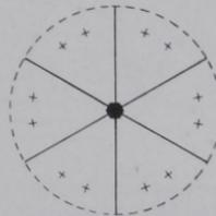
Fig. 211. Erzeugende Symmetrie der dihexagonal-pyramidalen Klasse ( $6 d$ ).
