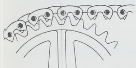
Abb. 2180. Eingriff nach Abnutzung der Zahnkette.
