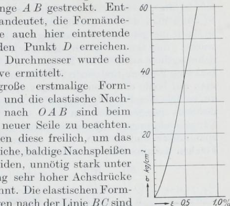
Abb. 2133. Spannungsdehnungslinie für im Betriebe befindliche Hanfseile.
