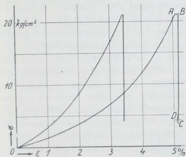
Abb. 2132. Spannungsdehnungslinien an neuen Hanfseilen. Nach Bach.
