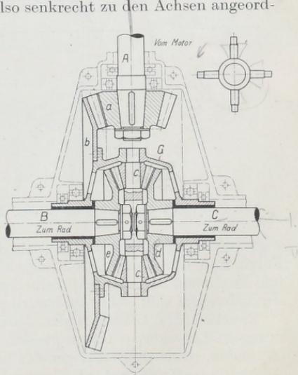
Abb. 1952. Kegelrad- und Ausgleichgetriebe an Kraftwagen.
