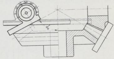
Abb. 1949. Nachprüfen der richtigen Lage von Kegelradgetrieben.
