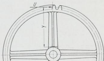
Abb. 1910. Zur Berechnung der Radarme.
