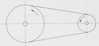
Abb. 1810. Mittelbar wirkende Treibräder. Riementrieb.
