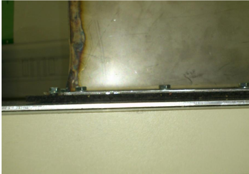
Abbildung 5-3 Detail Dämpfungszwischenlage-Fundament, würfelförmige Kapsel
