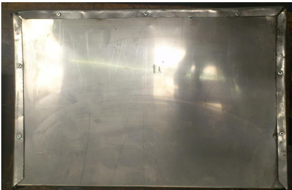
Abbildung 5-6 Nietverbindung der quaderförmigen Kapsel 0,5 mm Ausführung
