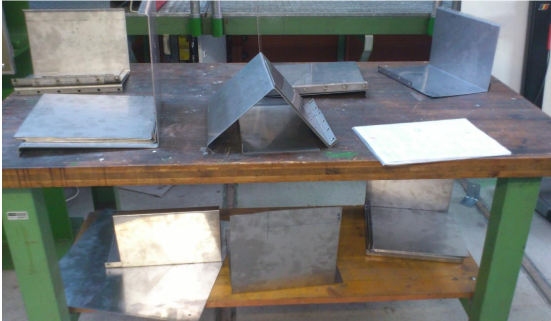
Abbildung 5-1 gebogene Mantel- und Abdeckbleche der verschiedenen Kapselungen
