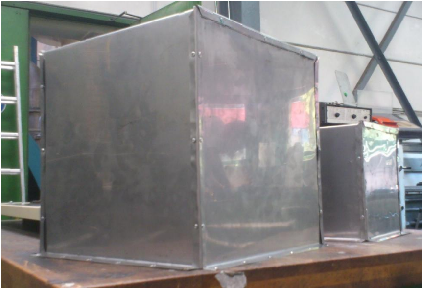
Abbildung 5-5 quader- und würfelförmige Kapselung in 0,5mm Ausführung
