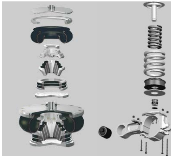
Abbildung 4.19: Federungssysteme: Sekundärfeder (rechts), Primärfeder (links) (Continental, 2015)
