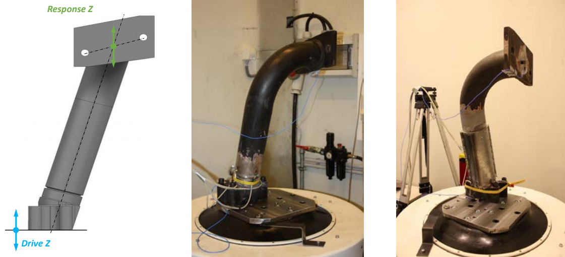
Abbildung 6.40: Shaker-Prüfaufbau des Schienenräumer
