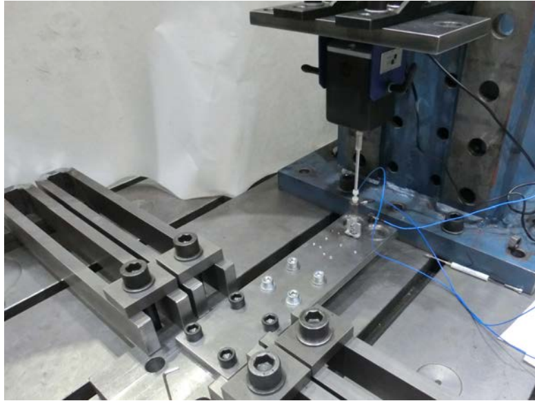
Abbildung 6.45: Prüfaufbau mit Shaker
