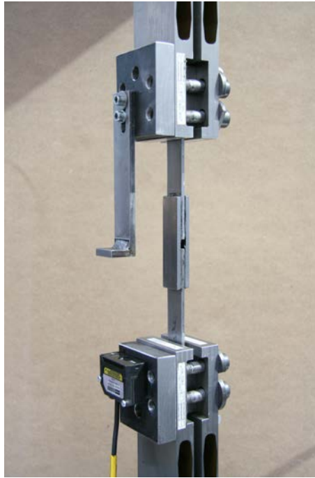
Abbildung 6.18: Probenform für Scherversuch
