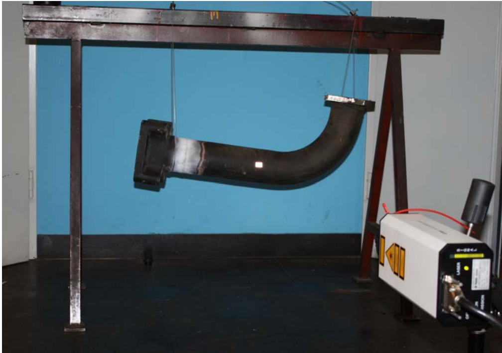
Abbildung 6.14: Versuchsaufbau 1 - Experimentelle Modalanalyse an einem Schienenrümer
