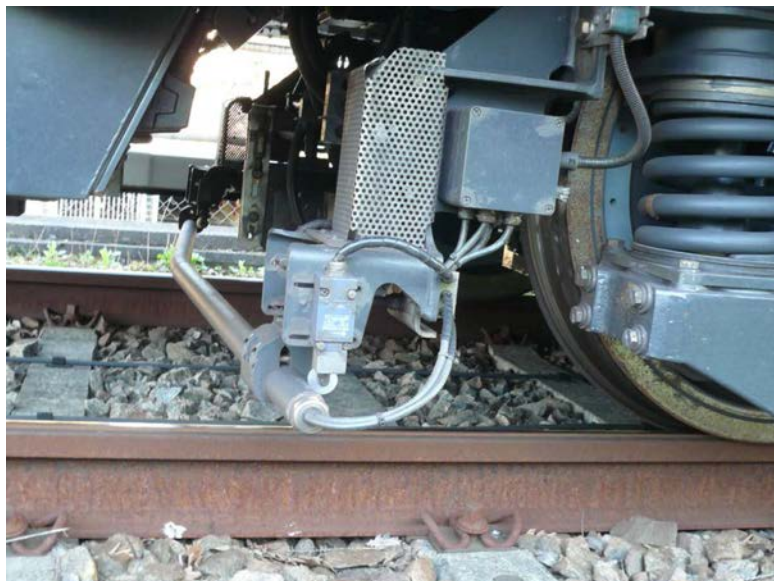
Abbildung 5.2: Aktiver Bahnräumer eines fahrerlosen Schienenfahrzeugs (Steingröver, 2013)
