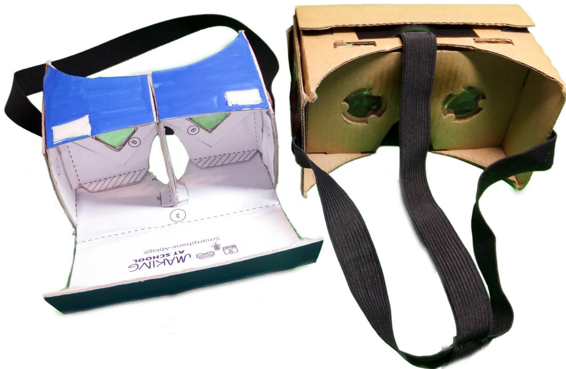
Abbildung 36: Zwei VR-Brillen aus unterschiedlichen Materialien: links eine von Making at School , rechts die von Thomas Lienhart zur Verfügung gestellte VR-Brille.
