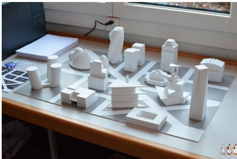
Abbildung 15: Die von Lernenden mit Tinkercad und SketchUp als 3D-Druck realisierte Stadt GüggelTown (3drucken.ch, Gregor Lütolf, 2015).
