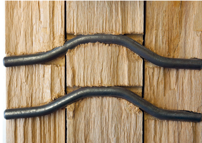
Abb. 24 Nagelverbindung mit plastischer Verformung
